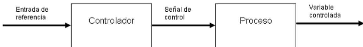
Figura 1.8 Diagrama de bloques de un sistema de control de lazo abierto
