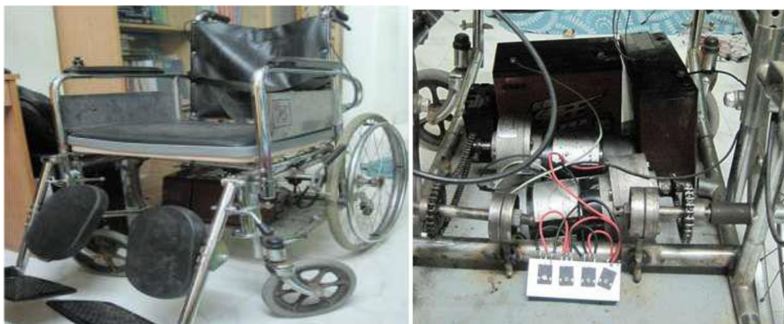
Figura 1.5 Silla de ruedas vista frontal (izq.) y sistema de transmisión (derecha) [4]
