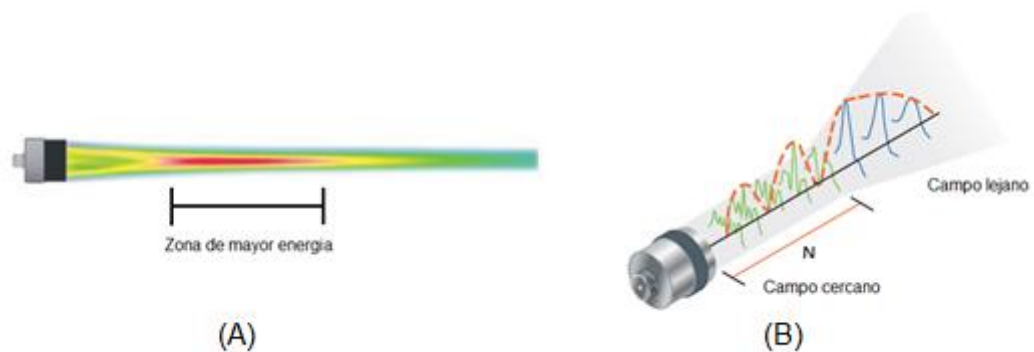
Figura 5: A) Perfil de haz ultrasónico, el color rojo representa las zonas de mayor energía mientras que azul y verde representan las zonas de menor energía. B) Campo cercano y lejano del transductor. Editado de OLYMPUS®, “Ultrasonic Transducers Technical Notes”
