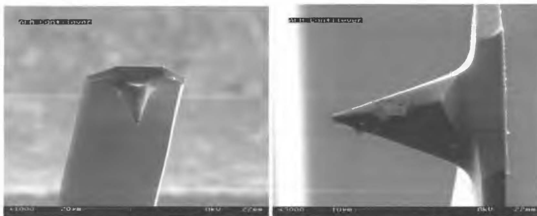
Figura 3.3.- Imágenes de puntas empleadas en AFM
