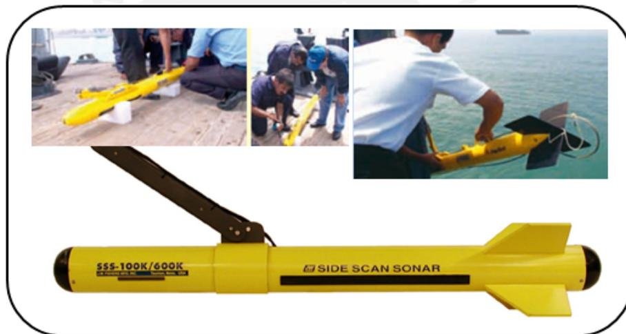
Figura N° 1.2. Side Scan Sonar y momentos de verificación antes de lanzarlo al agua.
