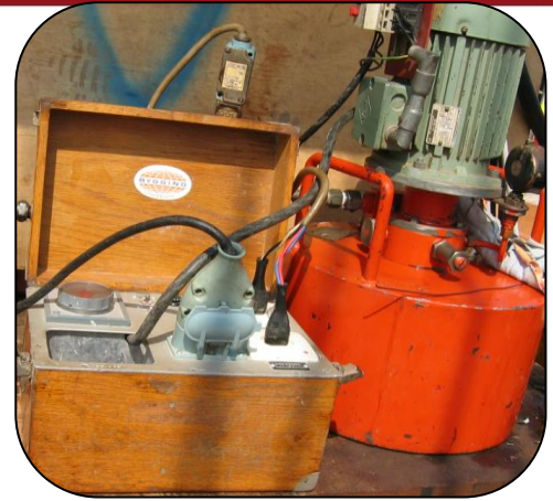
Fig. 2.14 Bomba de aceite y su dispositivo de control automático.
