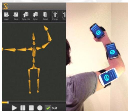
Figura 2.6.1: Simulación del movimiento de un brazo usando 3 celulares Galaxy S3
