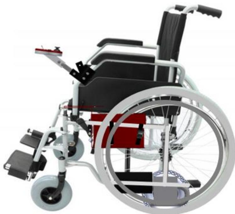
Figura 4.2.11: Silla de ruedas con el acople mecatrónico diseñado, soporte para electrónica y mando (Se obvia el acople derecho para una mejor visualización)
