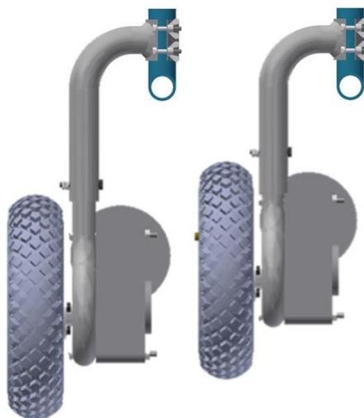
Figura 4.2.5: Elevación de 25mm del acople
