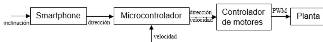
Figura 8.1.1: Diagrama de control lazo abierto del sistema
