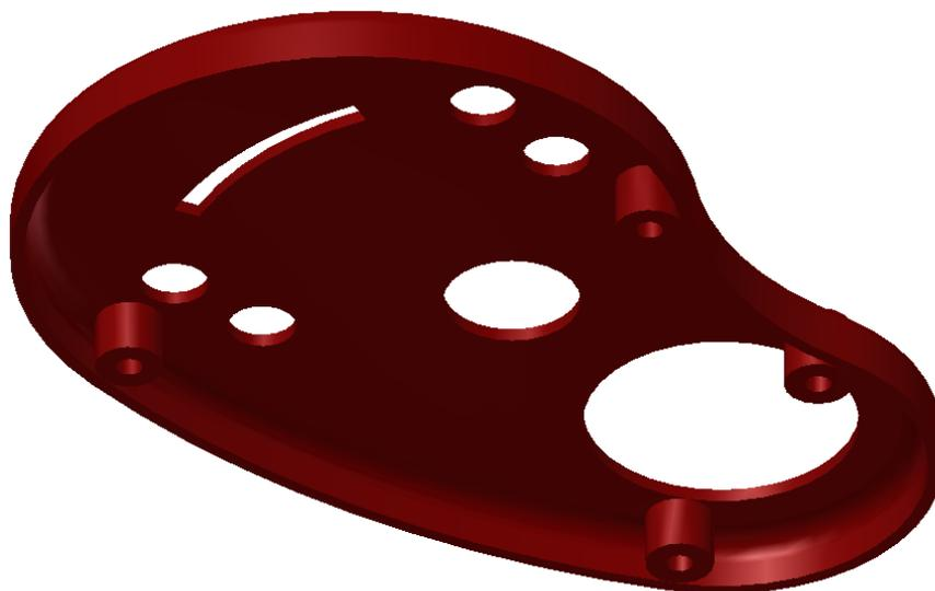
Figura 6.2.7: Vista isométrica de la carcasa superior
