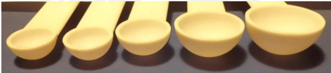
Figura 15. Semiesferas patrón utilizadas para el primer experimento en el cual se halló el error porcentual de estimación de volumen comparando el volumen nominal con el volumen estimado.
