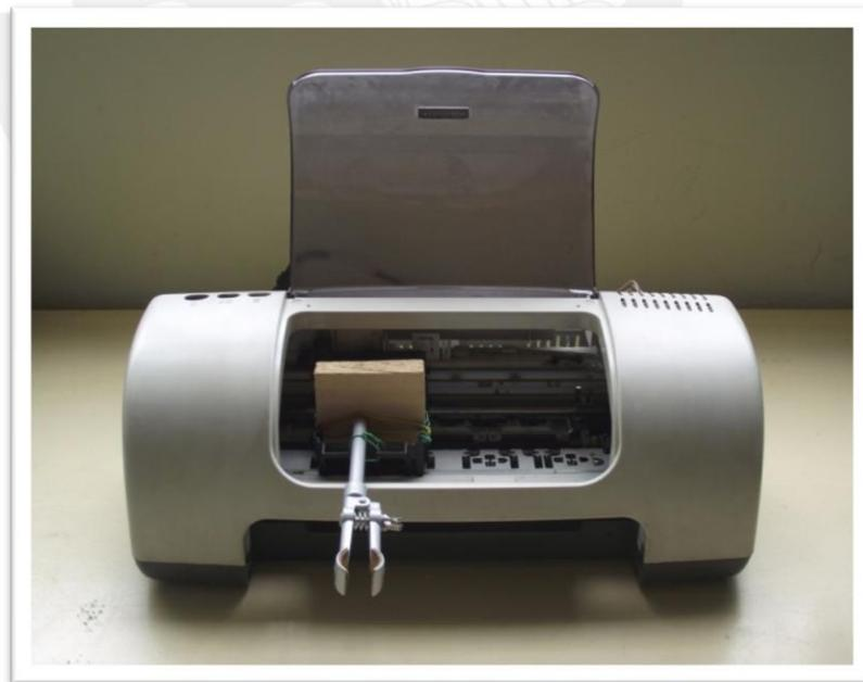
**Figura 3. Montaje mecánico, adaptado a partir de una impresora, utilizado para la toma de imágenes bidimensionales de separación, entre ellas, constante y conocida. El movimiento del equipo es en una sola dimensión y se inicia mediante un pulsador.**
