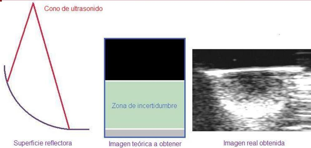
Figura 23. Explicación de la obtención de una imagen mal definida: la superficie, al tener elevaciones, se afectará la calidad de las imágenes bidimensionales obtenidas, ya que la resolución elevacional producirá artefactos.
