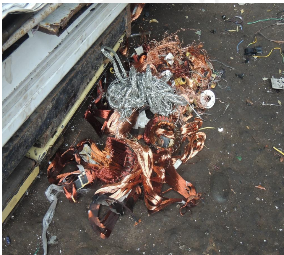
Figura 3: Cobre extraído después de desmantelamiento de RAEE en la vía pública. Fecha de la toma: junio de 2013
