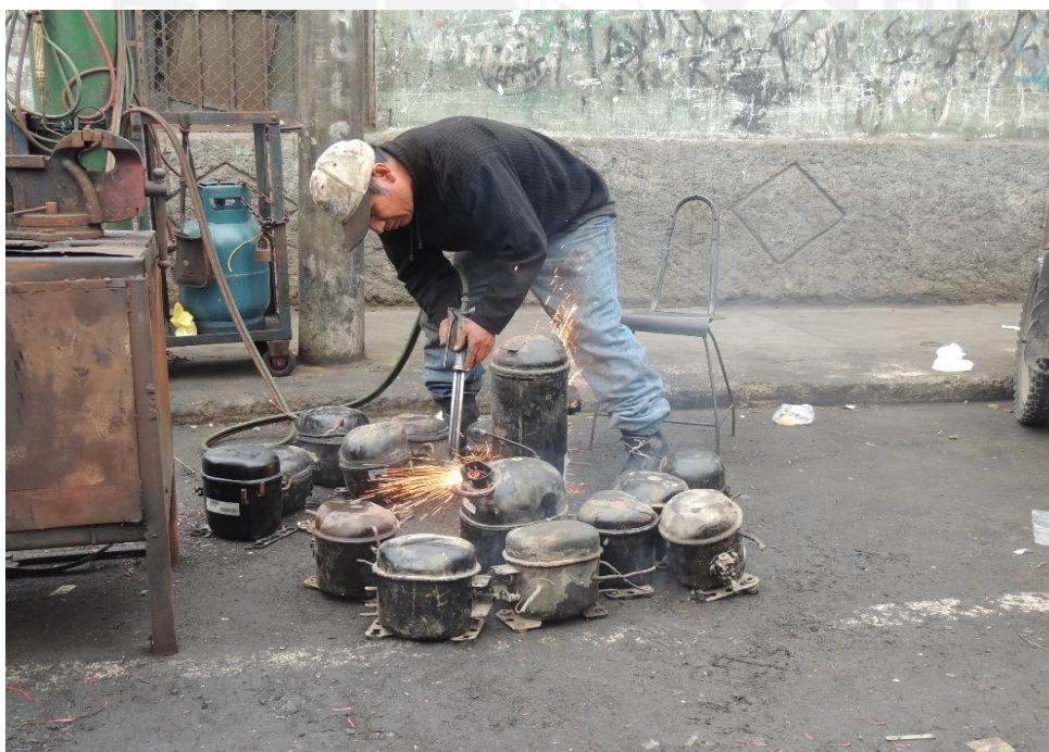
Figura 5: Hombre desmantelando motores de refrigeradora. Fecha de la toma: junio de 2013
