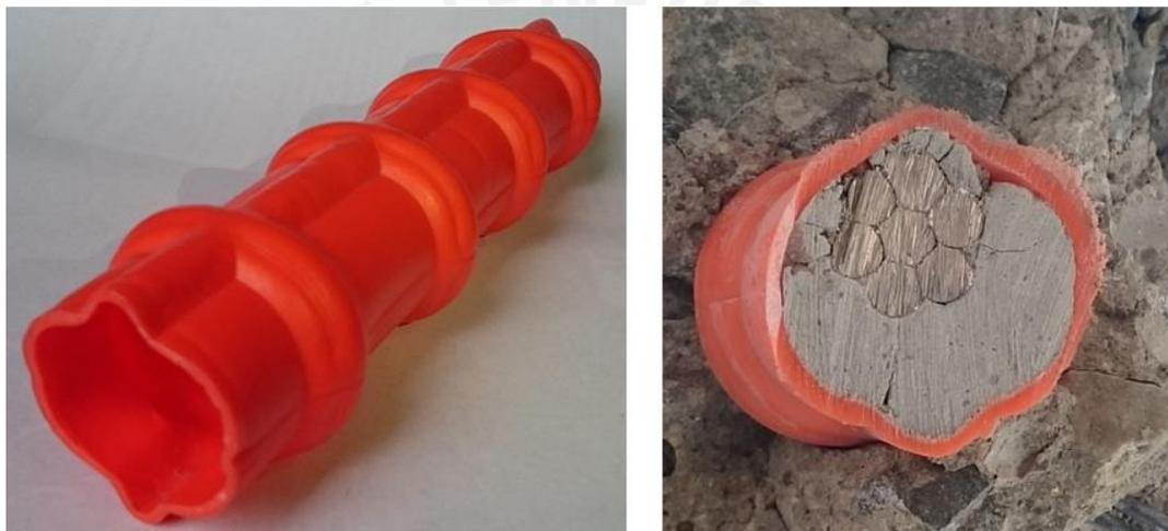
Fig. 2.15 Ducto de plástico y sección transversal de tendón adherido con inyección de mortero
