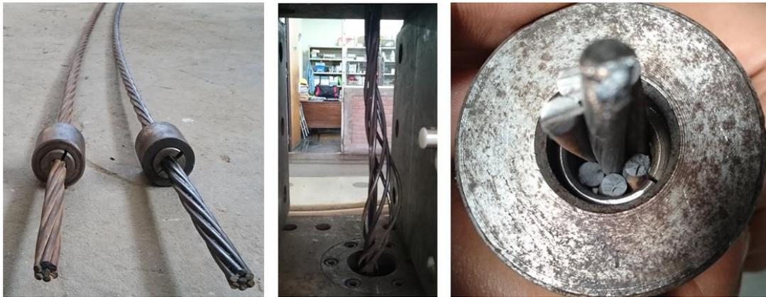
Fig. 5.14 Tendón adherido y no adherido con anclajes para ensayo (izquierda), destrenzado de tendón después de rotura (centro) y rotura de tres de alambres en el anclaje (derecha)
