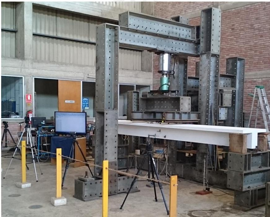
Fig. 5.18 Dispositivo de ensayo para las vigas
