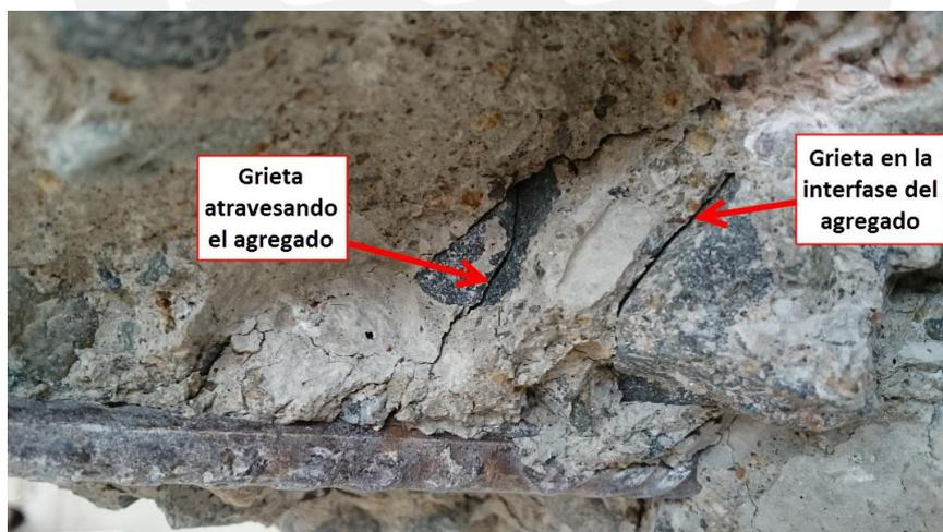
Fig. 2.3 Agrietamiento observado en el concreto en la zona en tracción de la viga VA-1
