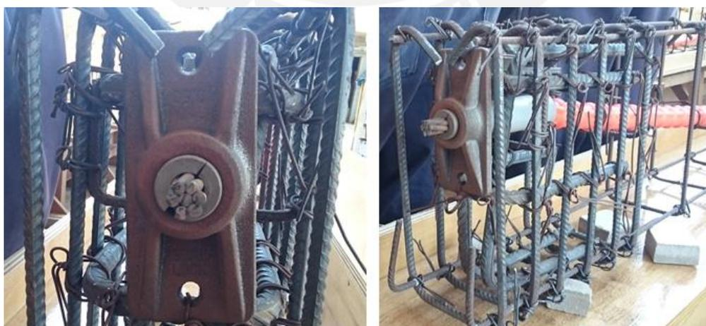
Fig. 5.1 Armadura y anclaje fijo en extremo de viga con tendón adherido
