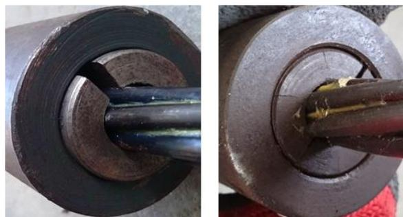
Fig. 5.13 Posición inicial de las cuñas antes del ensayo (izquierda), penetración y fractura de las cuñas después de la rotura del tendón (derecha)
