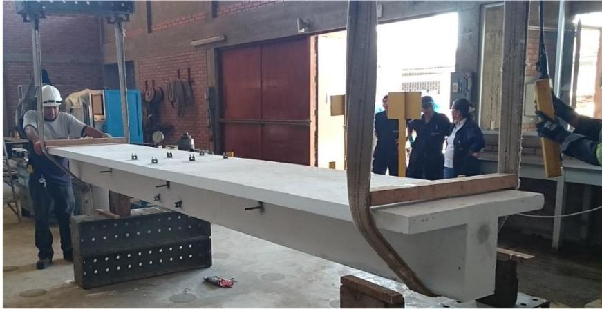
Fig. 5.17 Izado de viga con el tendón no adherido mediante dos puntos
