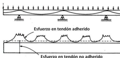
Fig. 1.3 Distribución de esfuerzo en tendones adheridos y no adheridos [1]
