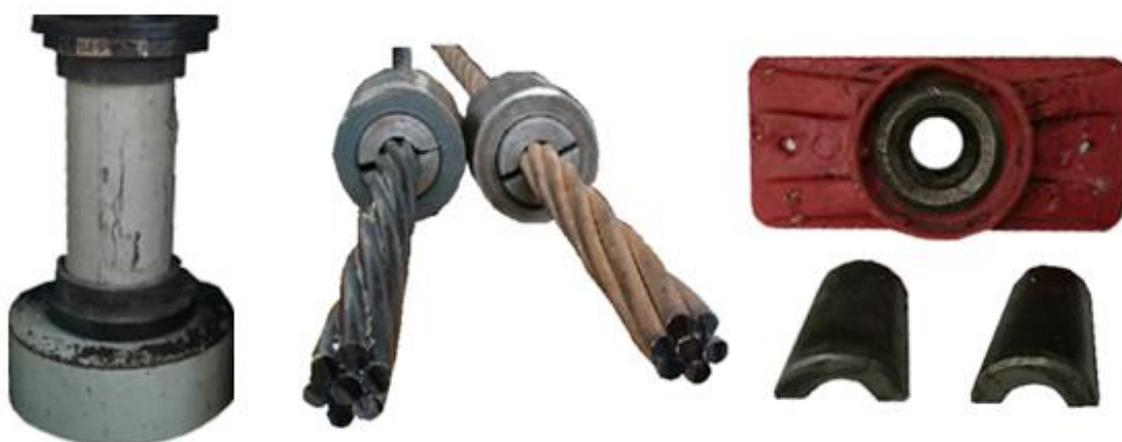
Fig. 2.1 Materiales en el concreto postensado: Concreto, tendones y anclajes
