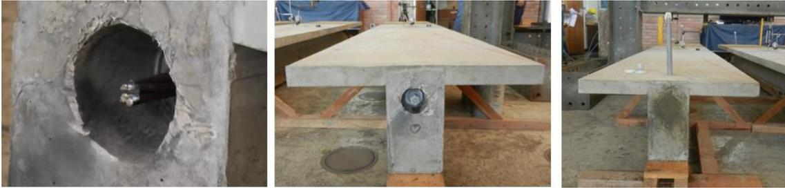
Fig. 5.8 Proceso final de tensado de vigas: cortado de tendón excedente, colocación de tapa anticorrosiva y sellado con material epóxico
