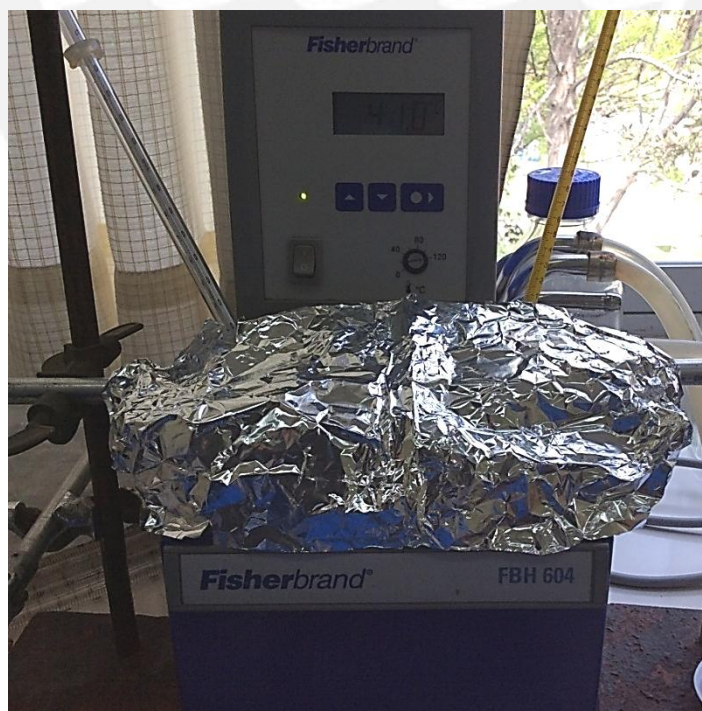
Figura 33: Sistema para el calentamiento de los hidrogeles, ensayo de contracción.
