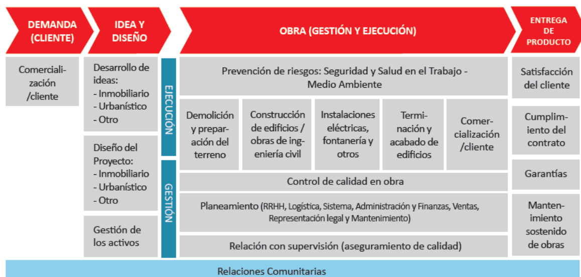
Figura 5. Flujo general de la actividad en construcción.
