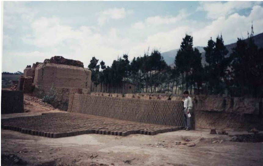
Fotografía N° 3.3: Ladrillos dispuestos de canto y en rumas
