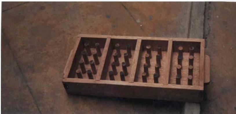
Fotografía N° 3.13: Gabera para 04 ladrillos de 7x13x23 cm., con 8 perforaciones, 9.27% de vacíos.
