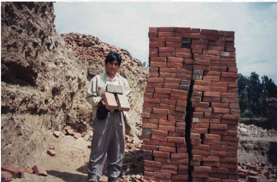
Fotografía N° 3.12: Ruma de ladrillo luego del quemado y listo para venta. Obsérvese la diferente coloración que refleja distintos grados de cocción
