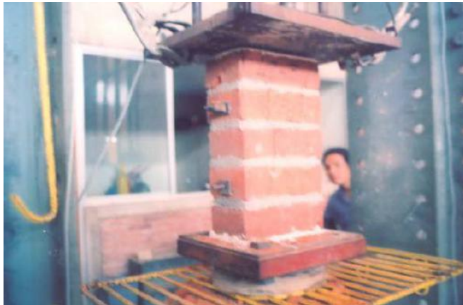
Foto N° 4.10: Muestra 3 del Lote de ladrillos mejorados y cocidos en el tercio superior del horno. Se observa agrietamiento vertical en la cara de mayor dimensión, cortando unidades y mortero.
