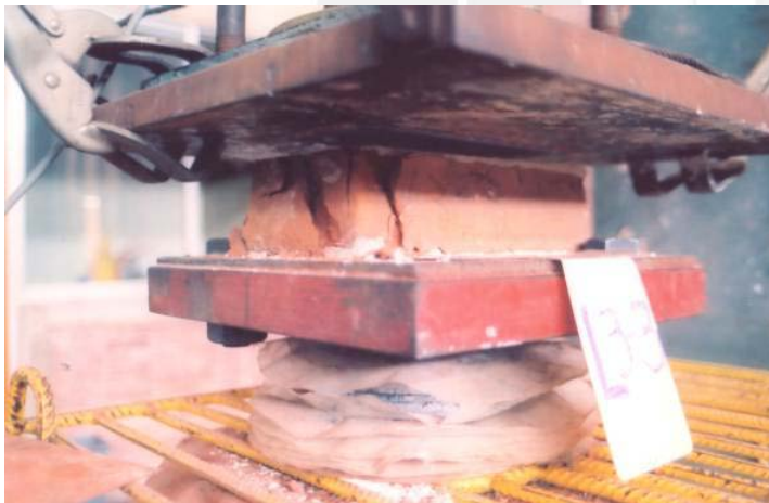
Foto N° 4.7: Muestra N° 3 del lote de ladrillos artesanales sin mejoras, cocido en la parte intermedia del horno. Se observa falla en uno de los extremos, zona más débil
