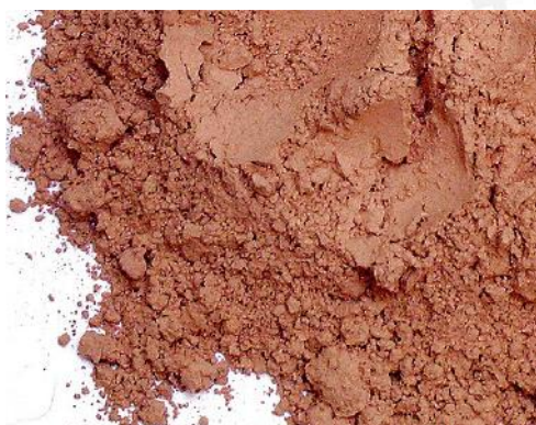
Fotografía N° 2.10: Crudo para fabricación de ladrillos. Cocida presenta tonos amarillentos ó rojizos según la cantidad de óxido de hierro en su composición ( http://drpez.net )
