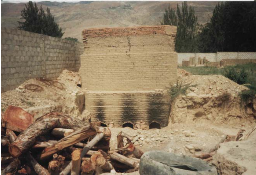
Fotografía N o 3.18: Horno de tres hogares, con capacidad para 25 millares de ladrillos KK 7x13x23, donde se quemaran nuestras unidades mejoradas
