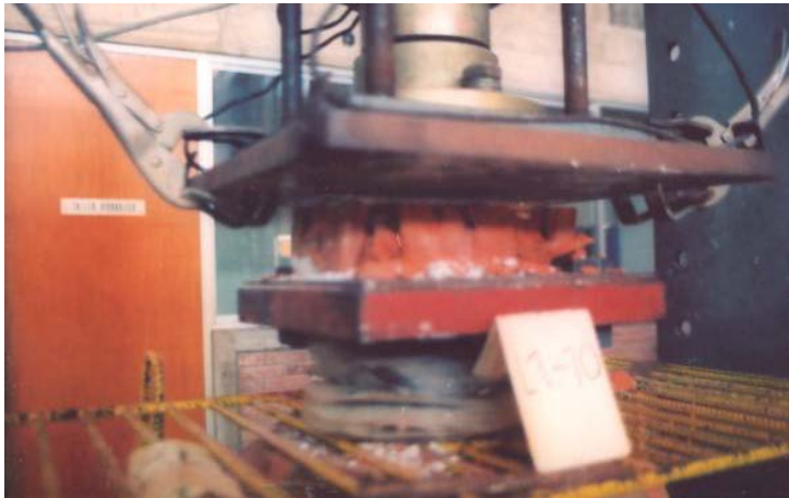
Foto N° 4.5: Muestra N° 10 del lote de ladrillos mejorados y cocidos en la parte intermedia del horno. Se observa falla por aplastamiento a lo largo de toda la unidad
