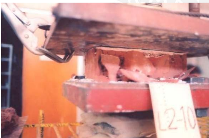
Foto N° 4.6: Muestra N° 10 de lote de ladrillos mejorados y cocidos en el tercio superior del horno. Se observa falla por aplastamiento a lo largo de toda la unidad.
