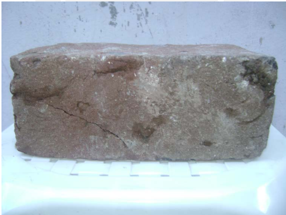
Fotografía N° 1.4: Grieta por contracción de secado en ladrillo artesanal
