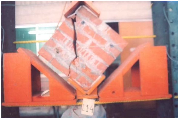
Foto N° 4.13: Muestra 4 del Lote de ladrillos mejorados y cocidos en el tercio intermedio del horno. Se observa falla vertical atravesando unidades y mortero lo que demuestra buena adherencia entre ambos.
