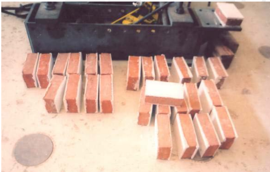
Fotografía N° 4.4: Unidades enteras refrentadas (capping) en las caras que estarán en contacto con los cabezales metálicos del equipo de ensayo.
