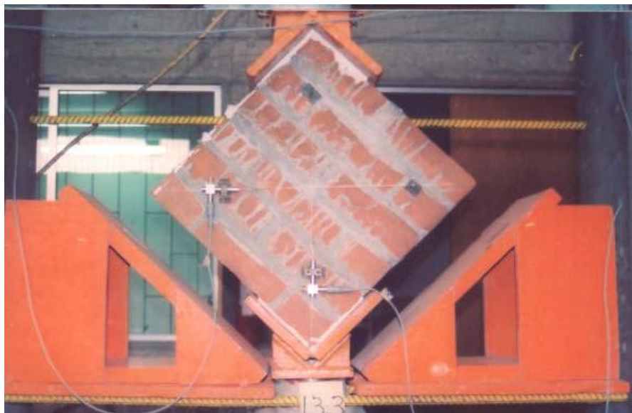
Fotografía N° 4.12: Ensayo típico de compresión diagonal en muretes. En este caso corresponde a la muestra 3 del Lote 3 (ladrillos artesanales cocidos en el tercio intermedio de horno).
