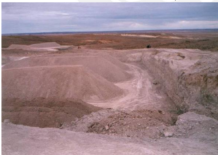
Fotografía N o 2.11: Yacimiento de Arcilla, explotada con maquinaria pesada con fines de industrialización ( http://segemar.gov.ar )
