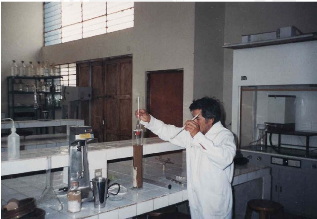
Fotografía N° 4.2: Ensayo de textura con hidrómetro.
