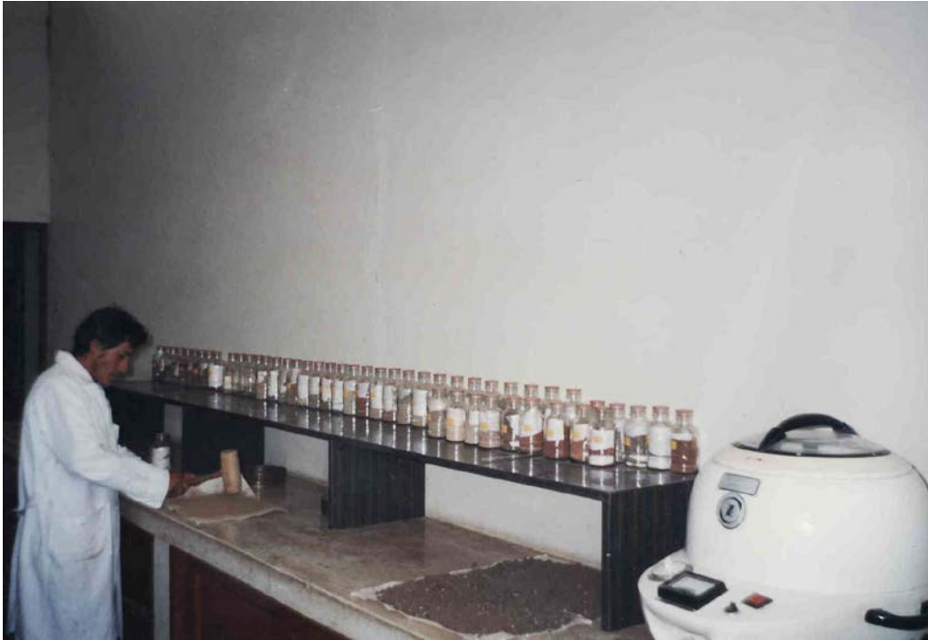
Fotografía N° 4.1: Preparación del crudo para realizar el ensayo de textura con el hidrómetro.
