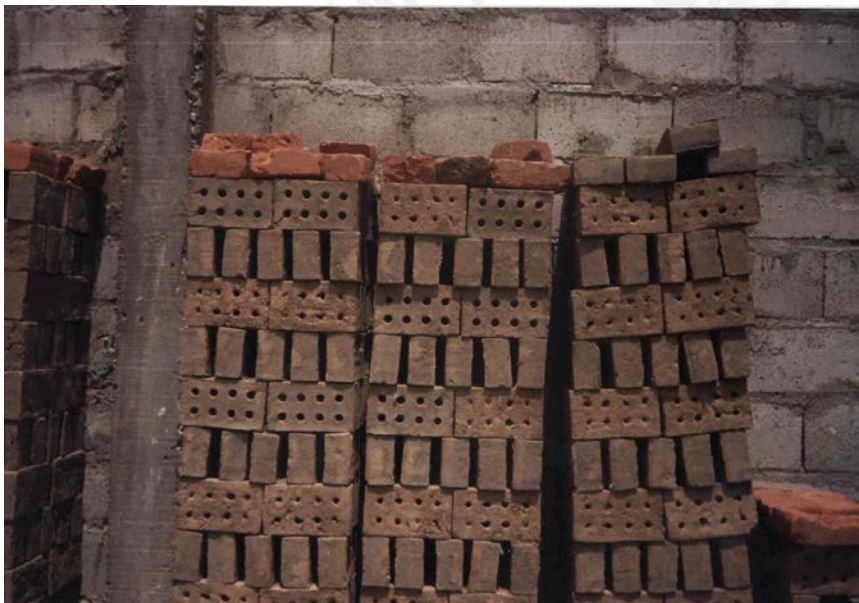
Fotografía N° 3.16: Disposición de ladrillos en rumas, para culminar el proceso de secado al aire libre.
