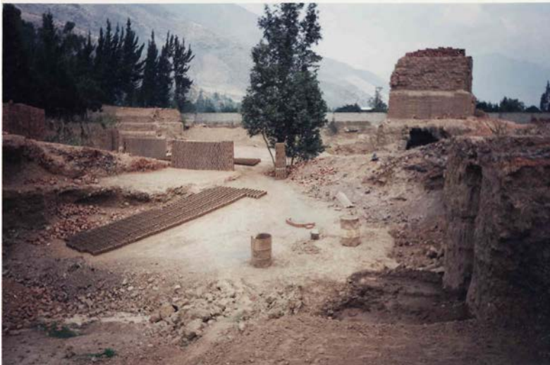
Fotografía N° 3.1: Material picado y crudo listo para moldeo
