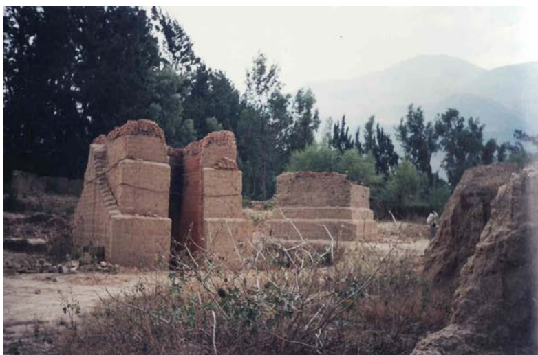
Fotografía N o 2.20: Horno intermitente, tipo chimenea de producción artesanal en Huánuco.
