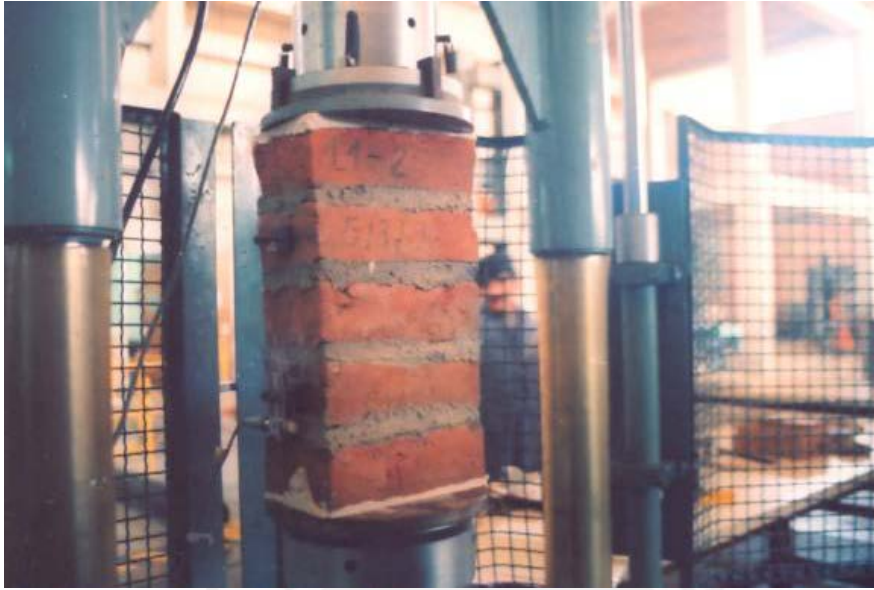
Fotografía N°4.8: Ensayo típico compresión axial en prismas, en este caso corresponde a la muestra 2 del Lote 1 (Ladrillos mejorados y cocidos en el tercio intermedio de horno).
