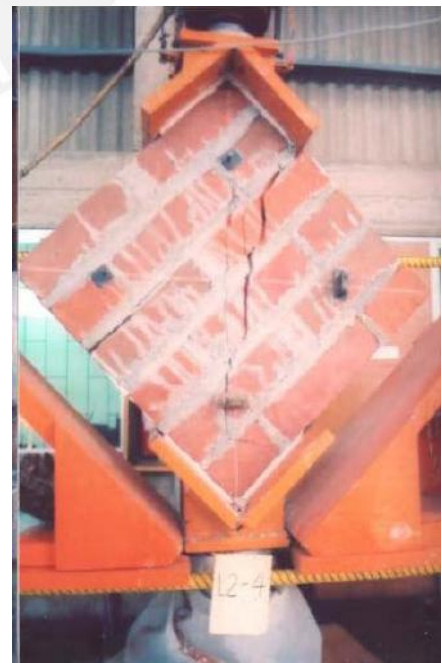
Fotos N° 4.14 y 4.15: Muestras 3 y 4 del Lote de ladrillos mejorados y cocidos en el tercio superior del horno. Se observa falla vertical atravesando unidades y mortero lo que demuestra buena adherencia entre ambos.
