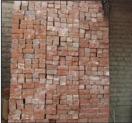
Figura 4.9, Ladrillo artesanal - diferente grado de cocción
