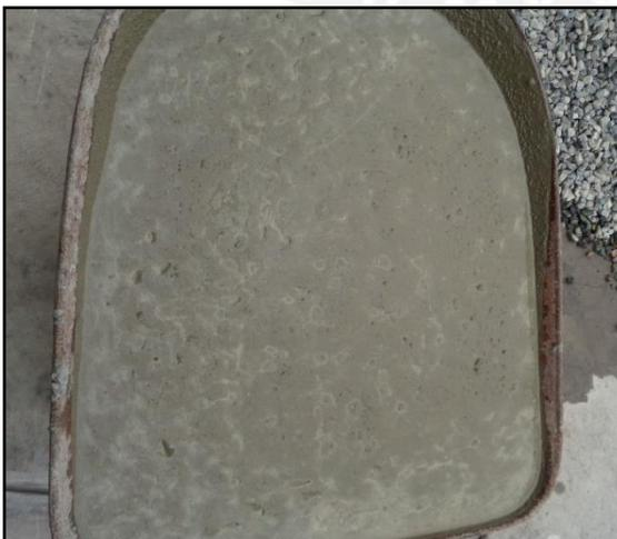
Figura 5.12, Exudación en concreto sin aditivo - Obra 5
