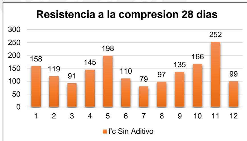
Figura 8.13, Resistencia Característica Sin Aditivo
