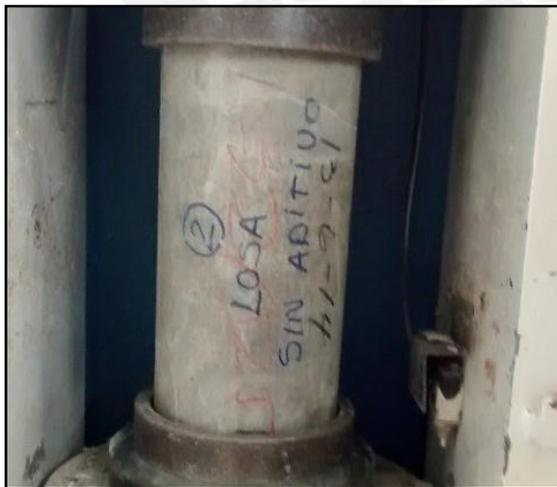
Figura 5.24, Rotura de Probeta
