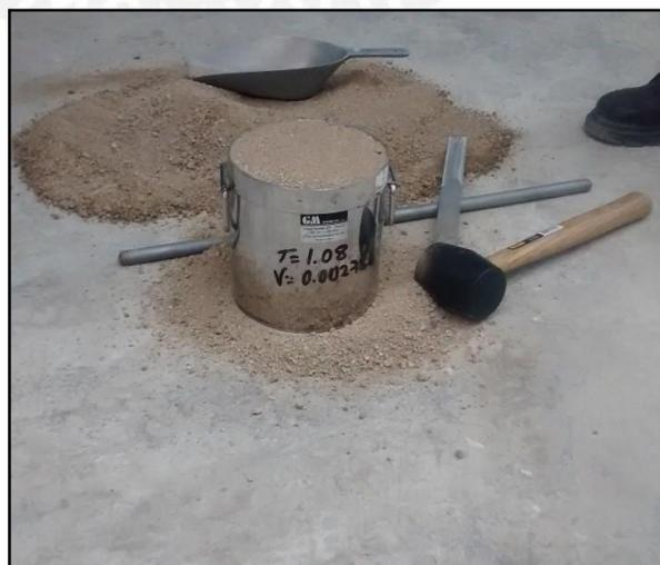
Figura 5.27, Ensayo de Peso Unitario
