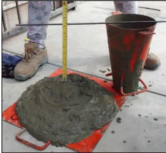
Figura 5.16, Concreto muy fluido de Slump = 8 1/2", aún mantiene la circunferencia; por lo tanto, no es derrumbamiento
