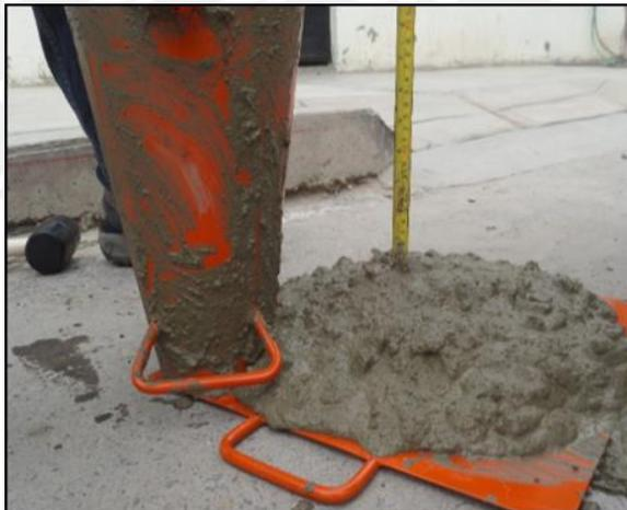
Figura 5.15, Asentamiento por derrumbamiento. Se observa un concreto muy fluido. Slump = 8 1/2"
