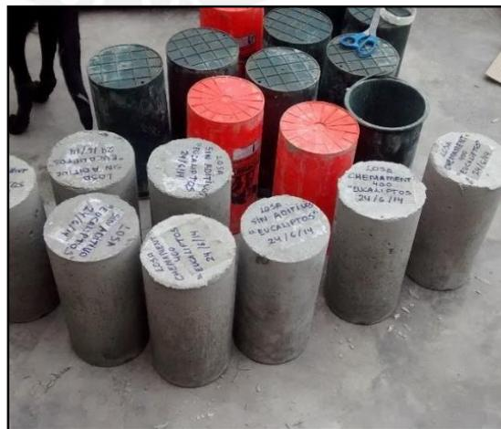
Figura 5.22, Desencofrado de probetas de concreto Fresco
