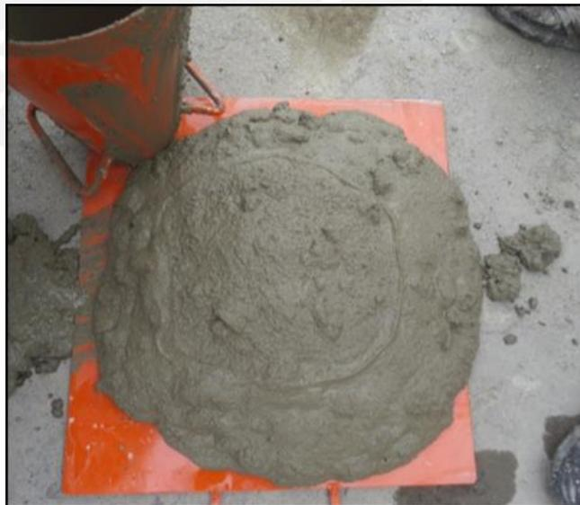
Figura 5.17, Concreto con alta fluidez - Slump = 9"
