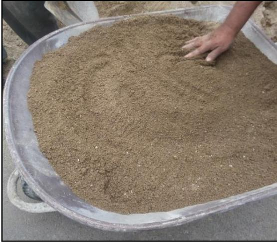
Figura 5.8, Agregado Fino notoriamente húmedo
