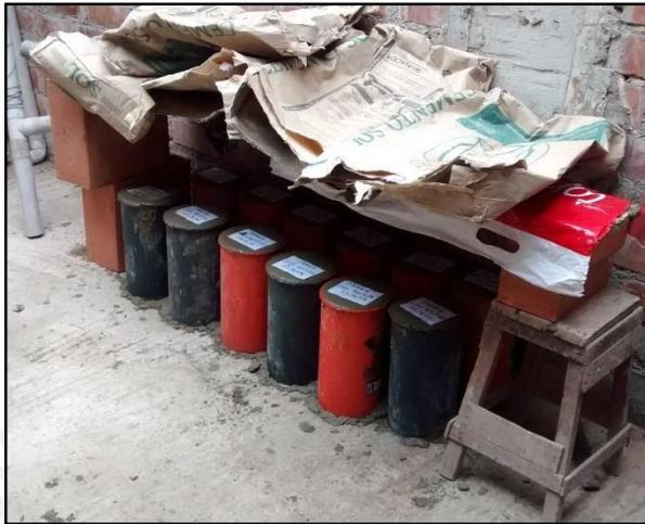
Figura 5.21, Almacenamiento de probetas de concreto
