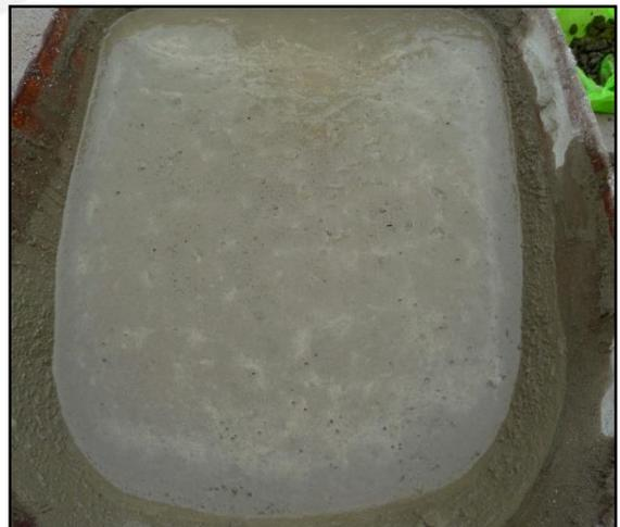
Figura 5.13, Exudación en concreto con aditivo - Obra 5
