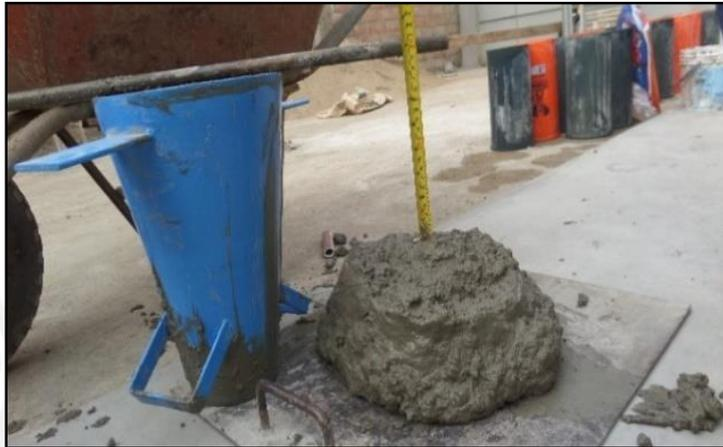
Figura 5.14, Asentamiento Original. Se observa un concreto bastante cohesivo y homogéneo a pesar de tener un Slump = 8"
