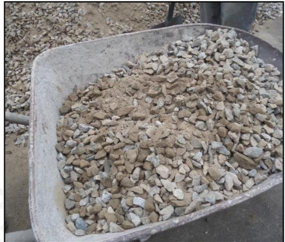
Figura 5.9, Agregado Grueso con presencia de material fino
