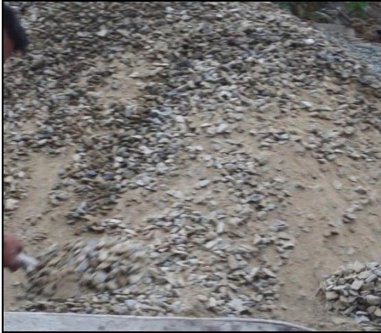
Figura 6.7, Cantidad de finos mezclados con el agregado grueso en Obra 1
