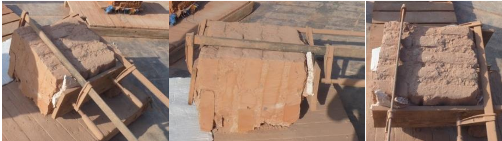
Fig. 55 – Preparación de los muretes de ladrillo (2)
