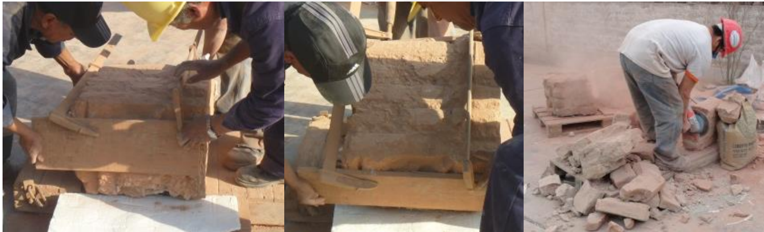
Fig. 56 – Preparación de los muretes de ladrillo (3)
