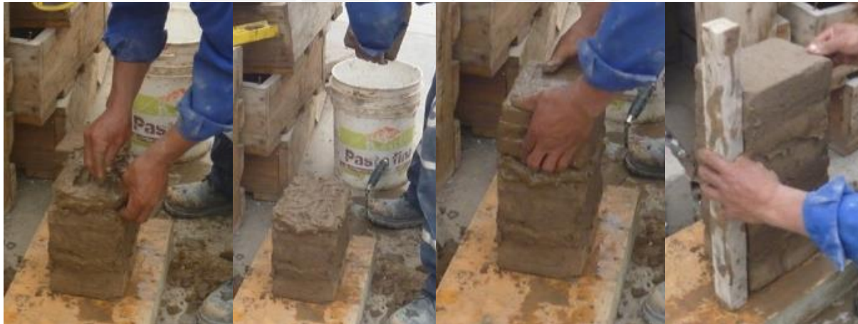
Fig. 45 – Construcción de las pilas de adobe (6)
