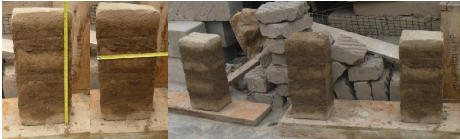
Fig. 46 – Construcción de las pilas de adobe (7)
