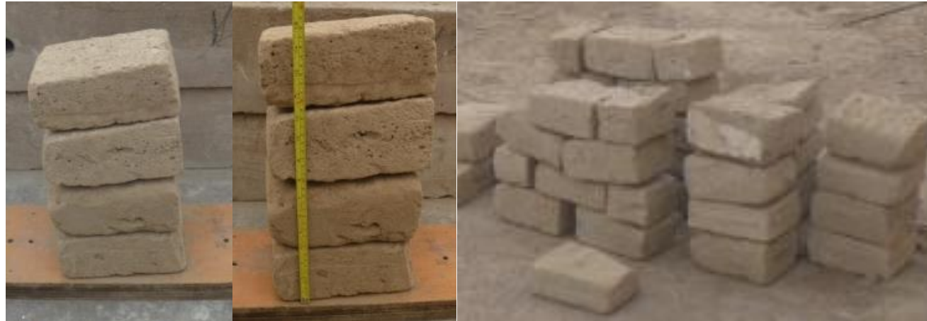
Fig. 42 - Construcción de las pilas de adobe (2)
