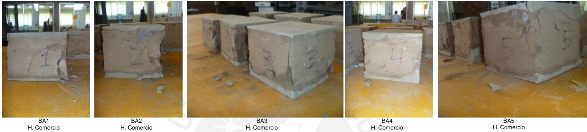
Fig. 73 – Bloques de adobe ensayados (3)
