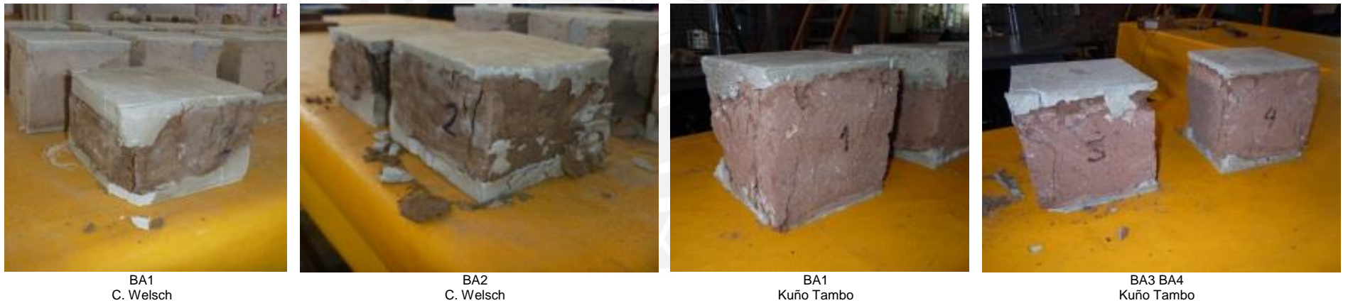
Fig. 74 – Bloques de adobe ensayados (4)
