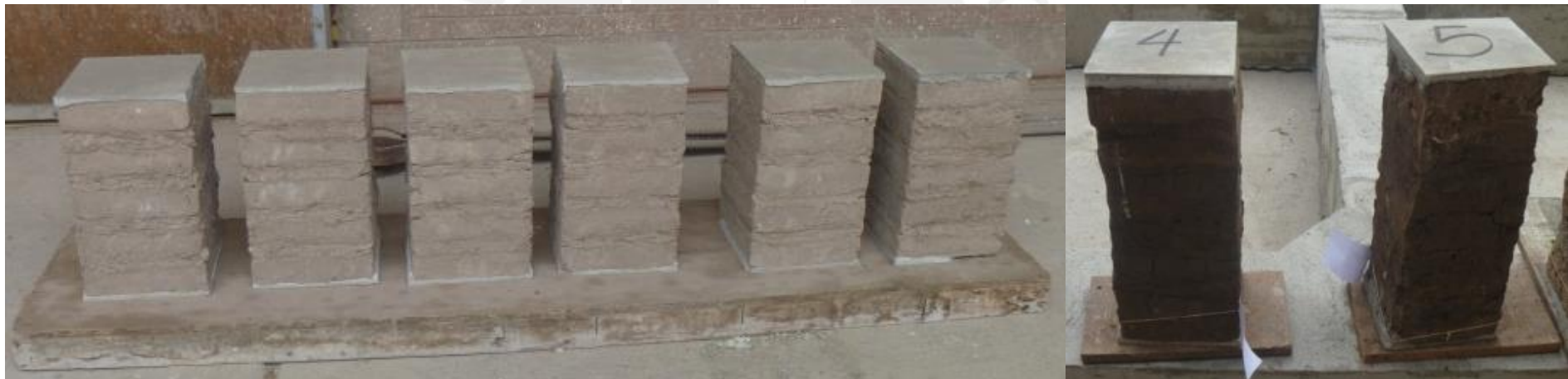
Fig. 47 – Construcción de las pilas de adobe (8)
