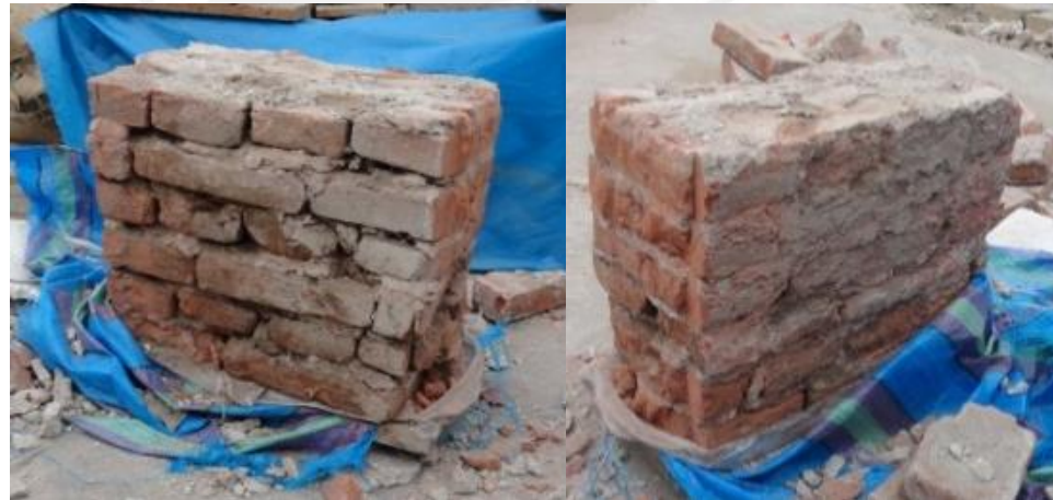
Fig. 54 – Preparación de los muretes de ladrillo (1)
