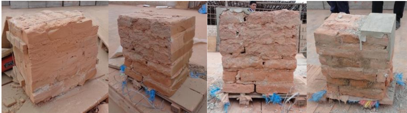
Fig. 57 – Preparación de los muretes de ladrillo (4)
