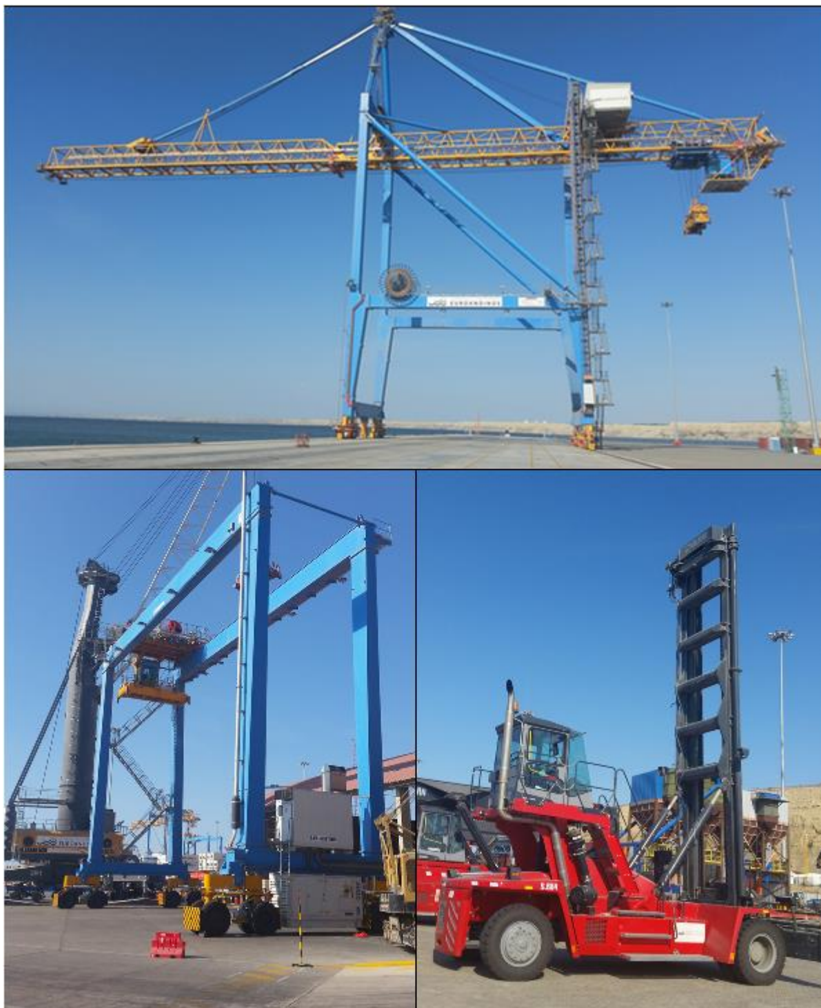
Figura 39. Imágenes del equipamiento del puerto Paita El puerto cuenta con: una grúa de pórtico Ship to Shore – Post Panamax, marca Liebherr (arriba), dos grúas de patio RTG marca Liebherr (Izquierda), y cinco “reach stacker” marca Kalmar (derecha)
