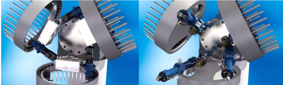
Figura 1.22. Control por paso variable: electromecánico e hidráulico [19].
