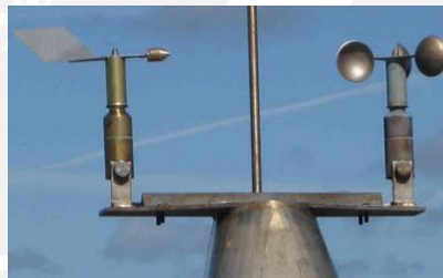
Figura 1.25. Anemómetro y veleta en la parte superior de la góndola [21].
