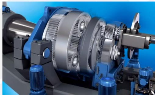
Figura 1.23. Reductor planetario con freno de emergencia [19].
