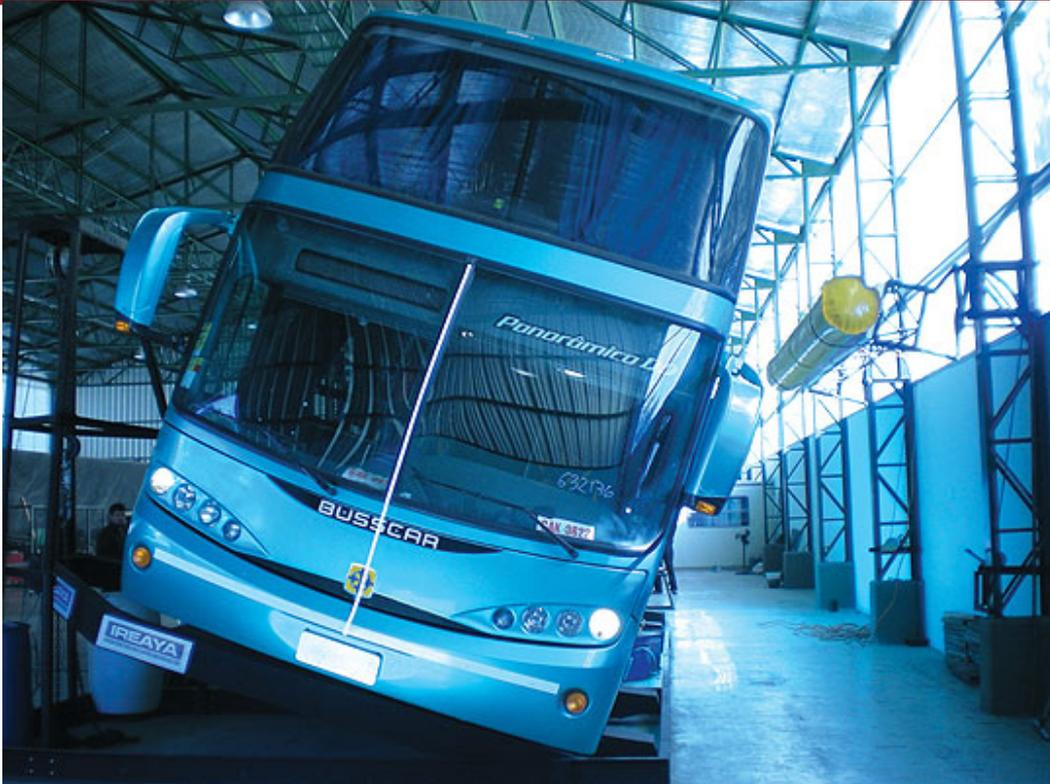
**Fig. 4:** En la actualidad el ensayo de inclinación lateral.
