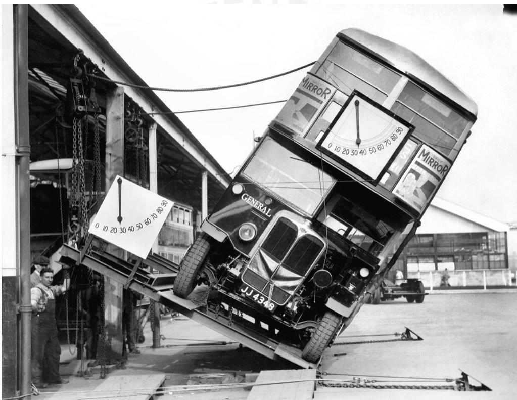
**Fig. 3:** Prueba de inclinación al famoso autobús de Londres.
