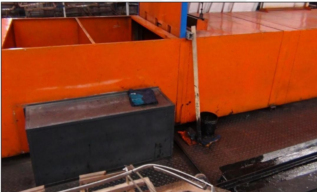
**Figura N° 11:** Techo del horno de curvado abierta sin letrero de advertencia.
