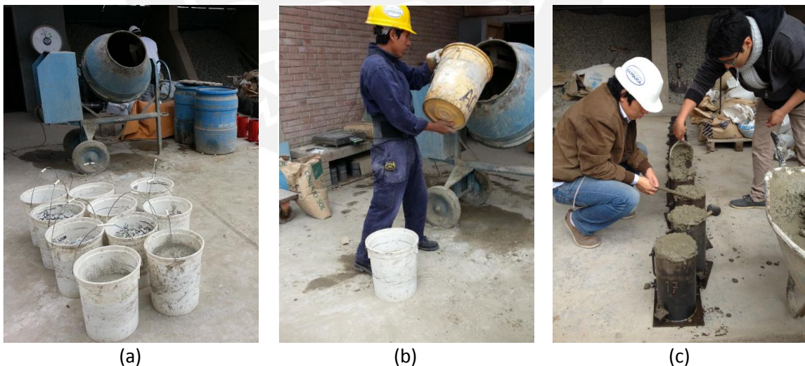
Figura 3.2. Preparación de la mezcla: (a) dosificación en peso; (b) mezclado; y (c) vaciado, vibrado y compactado de los especímenes.
