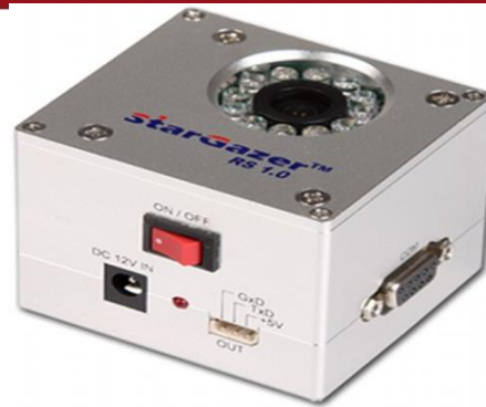
Figura 3.2.6: Sensor de localización StarGazer
