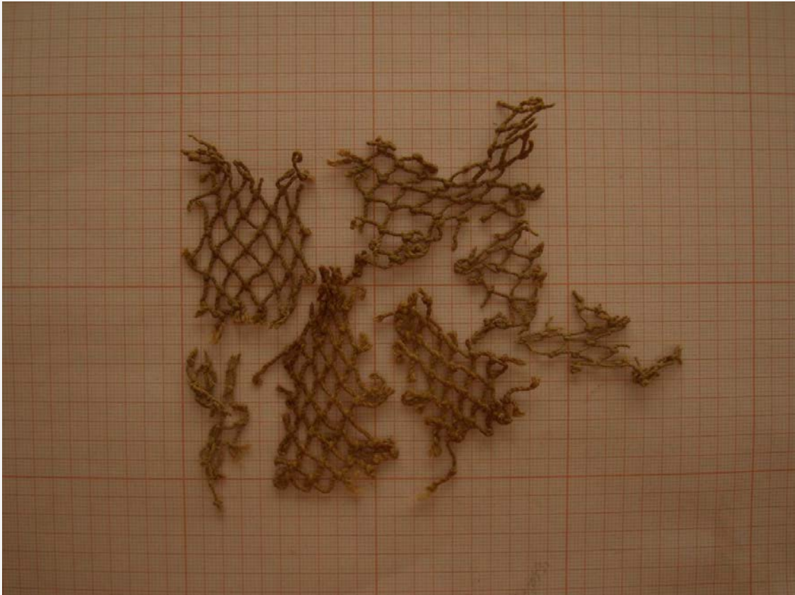
Figura 17. Ejemplo de red sobre hoja de papel milimetrado para medirle el área.
