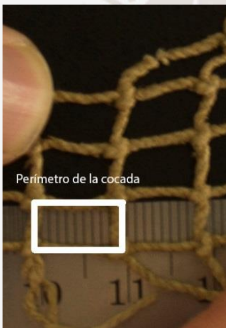
Figura 5. Medición del perímetro de la cocada.
