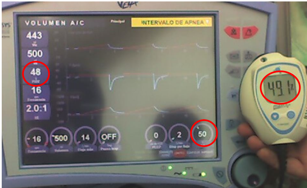
Figura 31: Verificación de valores en el monitor – prueba B
