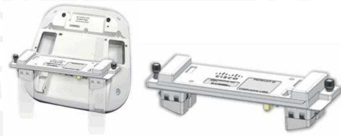
ILUSTRACIÓN 1-13: IZQUIERDA (CISCO AP SERIE 3600), DERECHA (MÓDULO WSSI)
