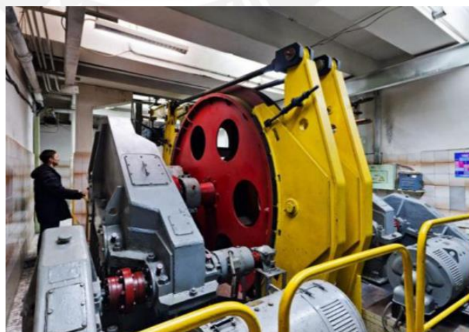
Figura 1.14: Zapata de freno en funicular de Kiev-Ucrania http://bashny.net/t/es/275841
