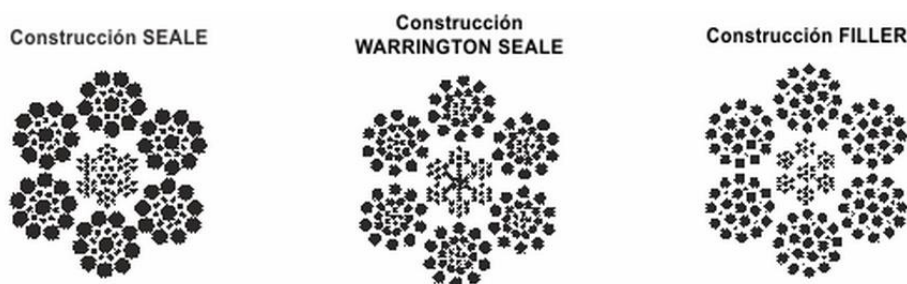
Figura 1.7: Construcciones de cables tractores comerciales. http://www.csbeaver.com/cablesdeacero.html
