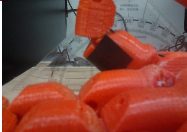
Figura 4.13: Resultado de la prueba a 45 grados en el dedo índice. Fuente: Elaboración propia En la prueba de 60 grados tenemos un valor en estado estable de aproximadamente 65 grados, mayores que los anteriores y el tiempo de subida se vio afectado en 0.2 segundos, este error no se percibe visualmente, similar que en los casos anteriores (ver Figura 4.14).
