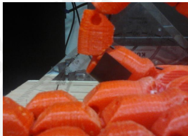
Figura 4.11: Resultado de la prueba de 40 grados en el dedo índice. Fuente: Elaboración propia
