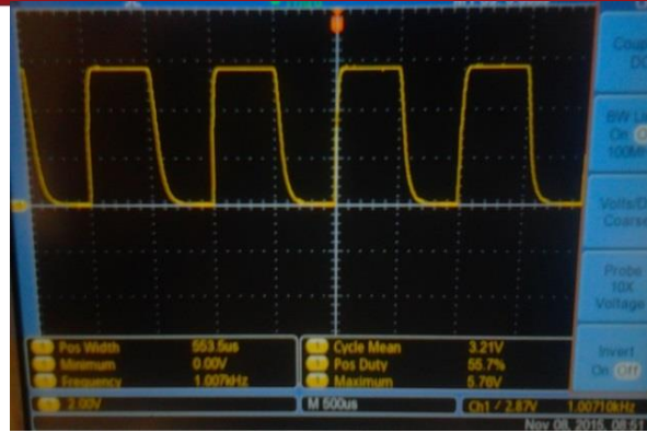
Figura 4.1: Prueba de funcionamiento del excitado de potencia. Fuente: Elaboración propia
