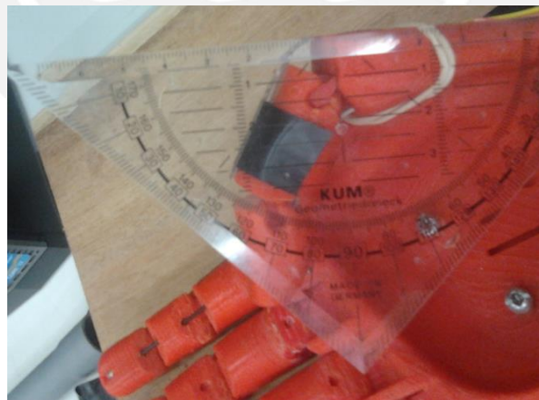
Figura 4.21: Resultado de la prueba a 60 grados en el dedo pulgar. Fuente: Elaboración propia
