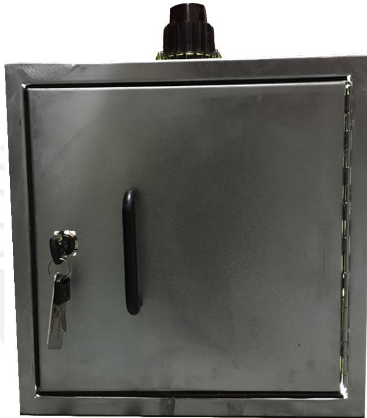
Figura 10: Cámara para la exposición de rayos UV con la lámpara acoplada en la parte superior.
