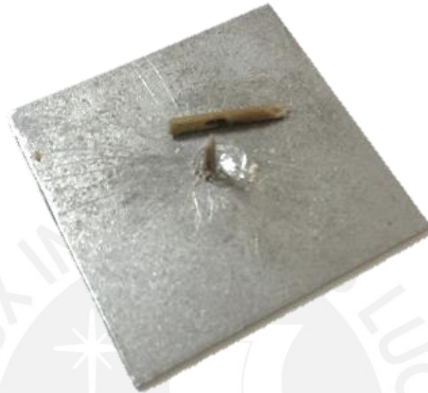
Figura 30: Modo de falla de la púa con degradación por rayos ultravioleta
