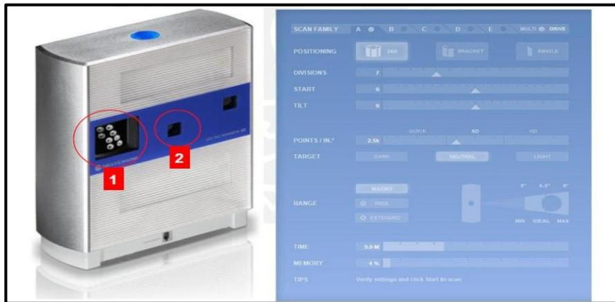
Figura 8: a) Montaje del NextEngine Laser Scanner HD con los siguientes componentes: la cámara CMOS (2) y los arreglos de láser (1); b) Interfaz de usuario del ScanStudioHD para controlar la adquisición del escáner, con sus modos de operación [3].
