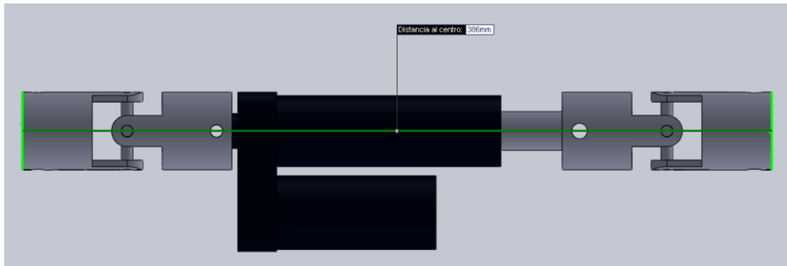
Figura 3.17 Longitud de la cadena cinemática final en estado inicial: 386 mm
