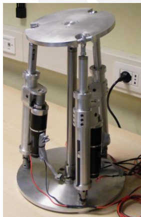
Figura 1.31 Utilización de servomotores lineales en mecanismos paralelos
