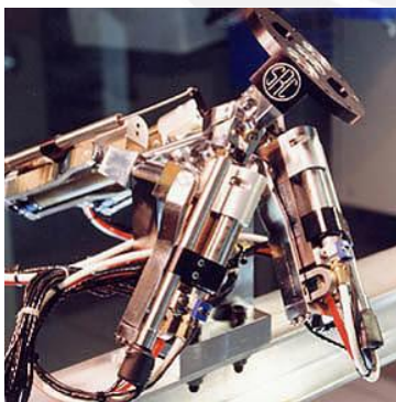
Figura 1.29 Aplicación de actuadores hidráulicos en robot paralelo
