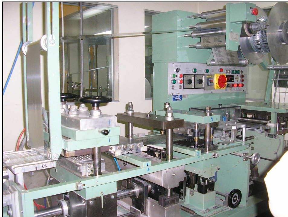
Figura 1.1. Máquina productora de blíster (blistera) en los laboratorios de INFARMASA
