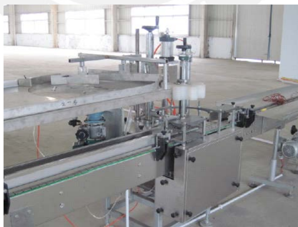
Gráfico 5: Máquina de tapado a presión automática
