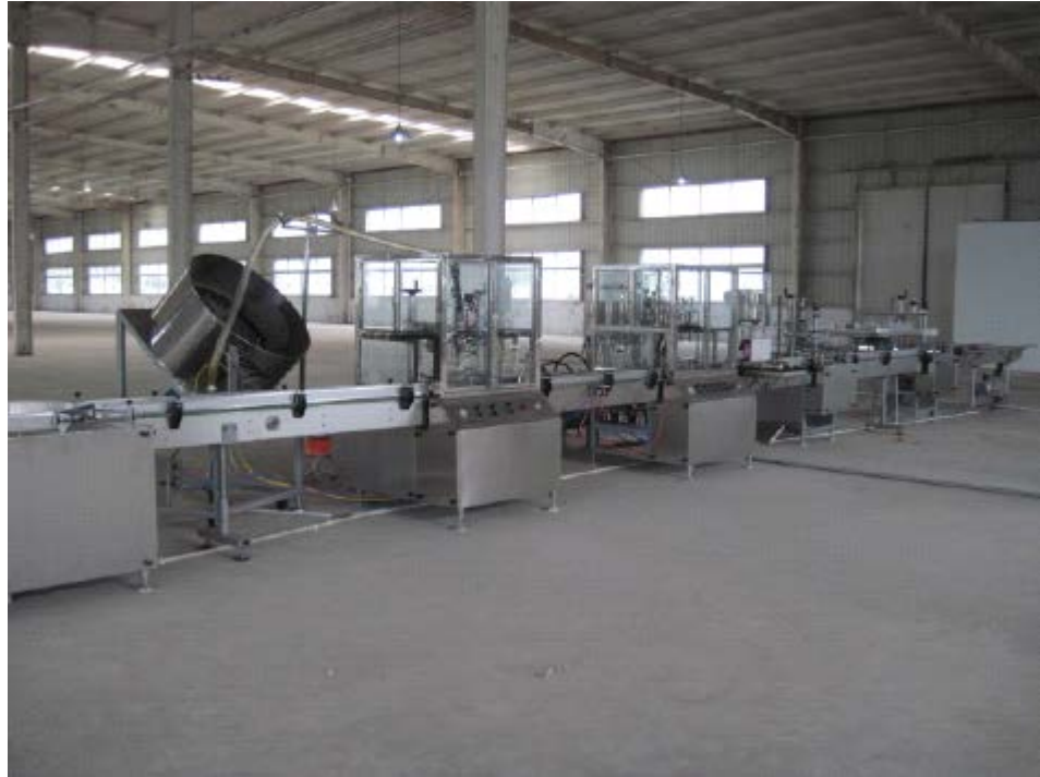
Gráfico 1: Línea de envasado de aerosoles
