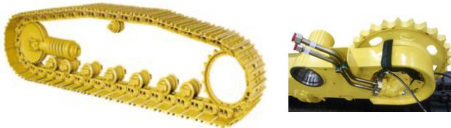
Figura 2.22: Vista Panorámica de la Oruga (izq.) y Ubicación del motor de avance motriz (der.)[26].
