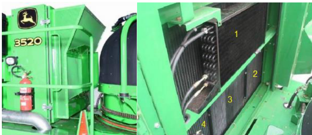
Figura 2.23: Vista Panorámica del Sistema de Refrigeración (izq.) y ubicación de sus componentes (der.)[27]
