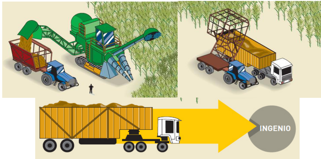
Figura 2.1: Cosechadora vertiendo caña procesada al Autovolteo (izq.), Autovolteo vertiendo caña procesada al Camión(Cañera) (der.) y Camión trasladando caña procesada al Ingenio (Fabrica) para la posterior conversión a Etanol (abajo) [12].
