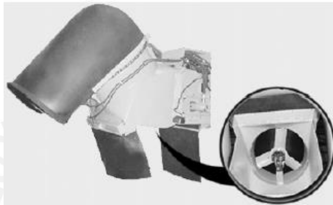
Figura 2.20: Vista Panorámica del Extractor Secundario y Ubicación del Motor del Extractor [13].
