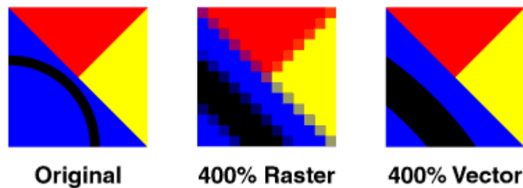
Figura 1.1: Variación de resolución para una imagen almacenada en mapa de bits y en forma vectorial. [3]
