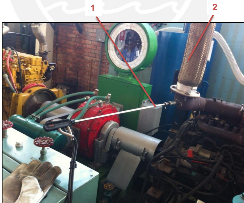
Figura 2.8 - Instalación del Testo 350 XL en el tubo de escape
