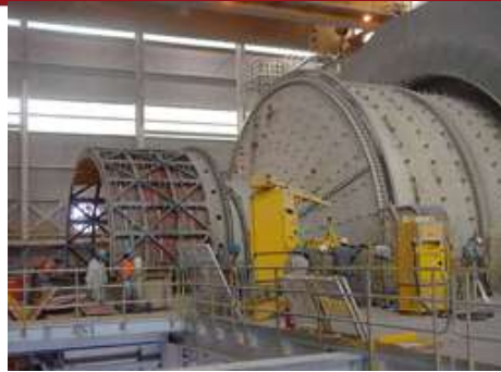
Figura 1.2 Molino de Bolas
