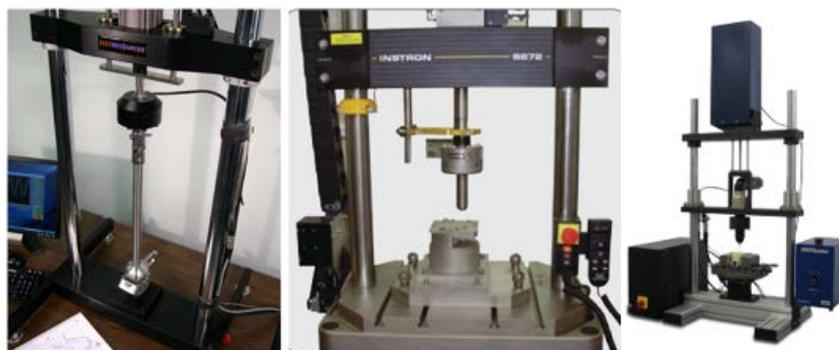
Figura 1.20. Máquinas de ensayo de tracción-compresión y/o torsión.
