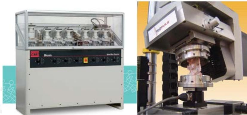
Figura 1.19. Máquinas de ensayo. a) *Bionix Spine Wear Simulator*. b) *BioPuls multi-axial spine testing system*.
