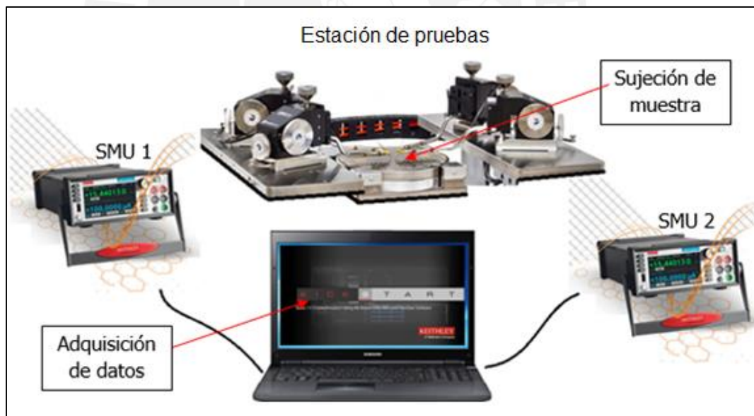
Figura 2.4. Composición general del sistema de medición y adquisición de características electrónicas de transistores de efecto campo que se implementa en este trabajo.
