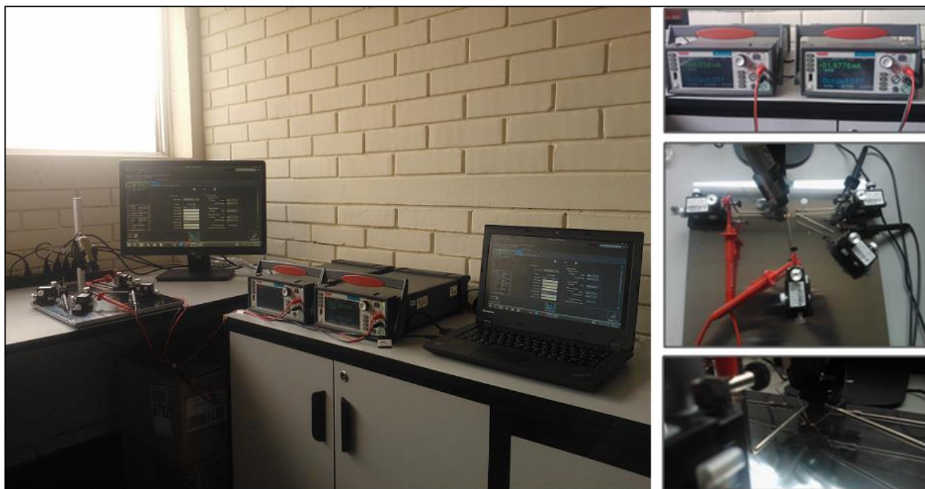
Figura 2.8. Ensamble de SMUs, Microposicionadores, puntas y sistema de adquisición configurada para la caracterización de propiedades electrónicas de transistores de efecto campo.
