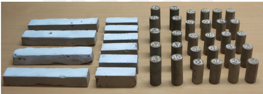
Figura 2.30. Especímenes para ensayos de flexión y compresión diametral de adobe y mortero.
