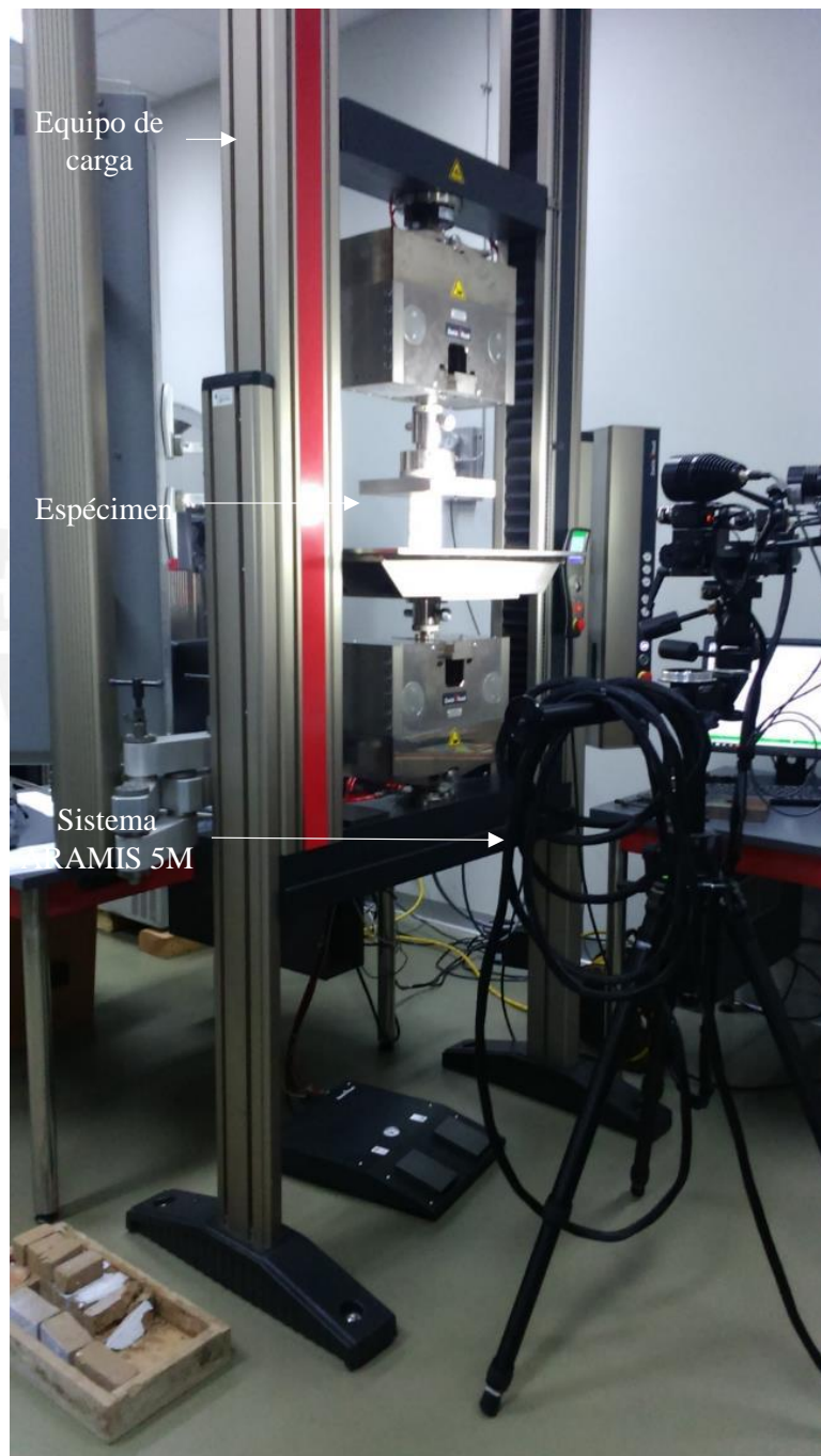
Figura 2.12. Equipos utilizados durante los ensayos de compresión de especímenes de adobe y mortero (maquina universal Zwick/Roell Z050 y sistema ARAMIS 5M).
