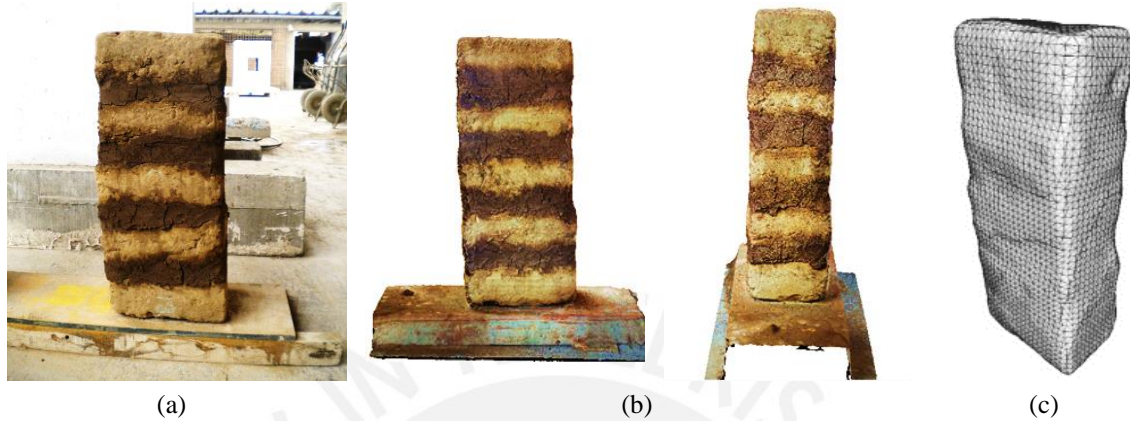
Figura 3.3. Reconstrucción fotogramétrica 3D (a) fotografía del prisma 03 (b) reconstrucción digital del prisma 03 y (c) malla de la reconstrucción digital del prisma 03.
