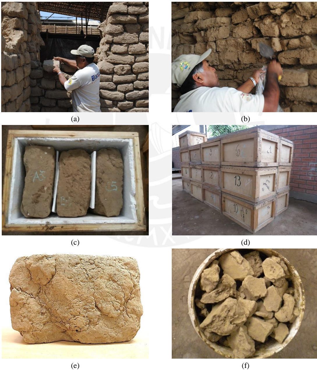
Figura 2.7. Material usado para la caracterización del adobe, mortero y mampostería de Huaca de La Luna (a) proceso de obtención de adobes (b) proceso de obtención de mortero (c) colocación de adobes en cajas (d) cajas en el laboratorio PUCP (e) adobe típico y (f) mortero original.
