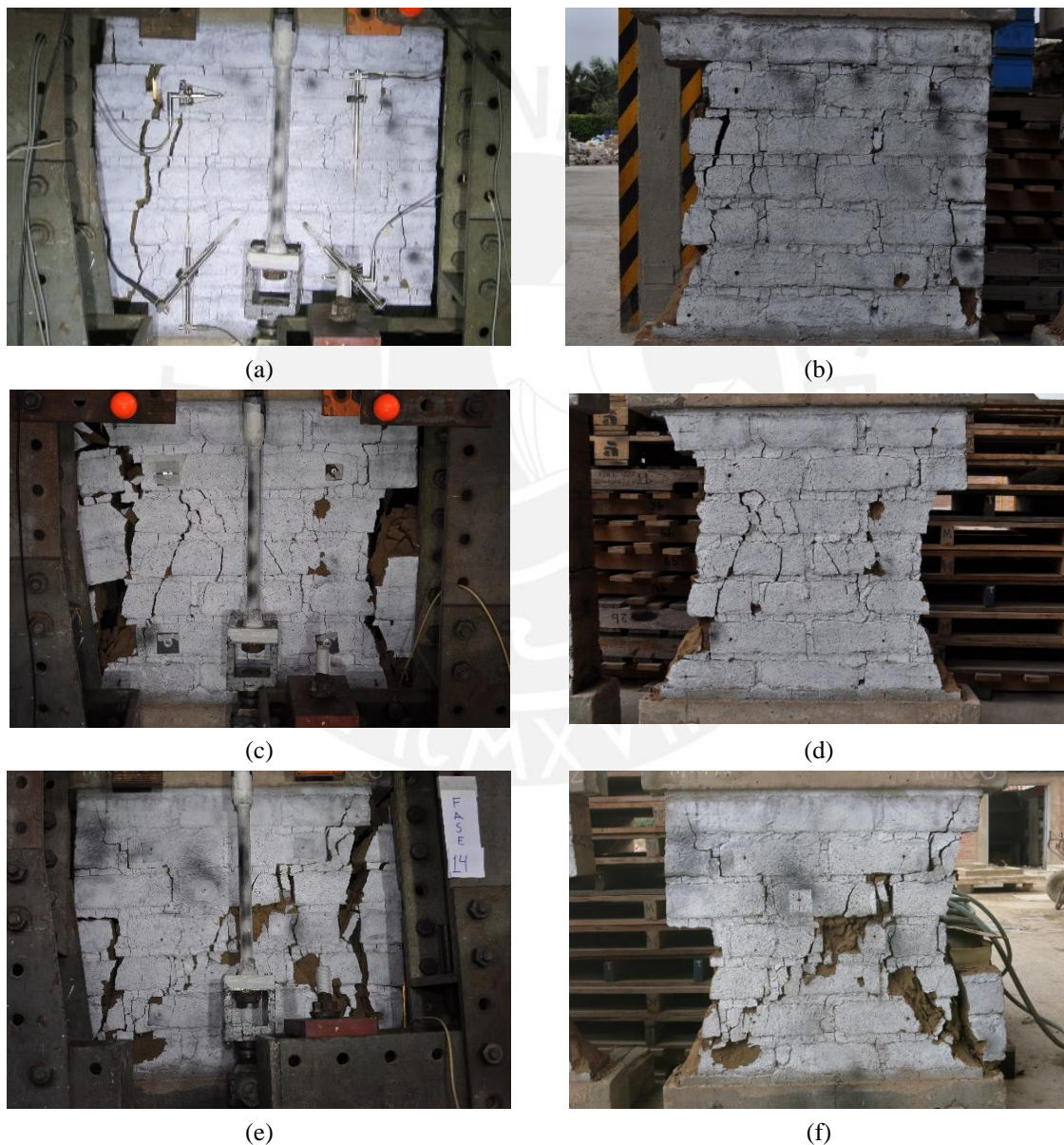
Figura 4.7. Modo de falla y colapso de los muros ensayados (a) muro 01 al final del ensayo (b) estado final del muro 01 (c) muro 02 al final del ensayo (d) estado final del muro 02 (e) muro 03 al final del ensayo y (f) estado final del muro 03.
