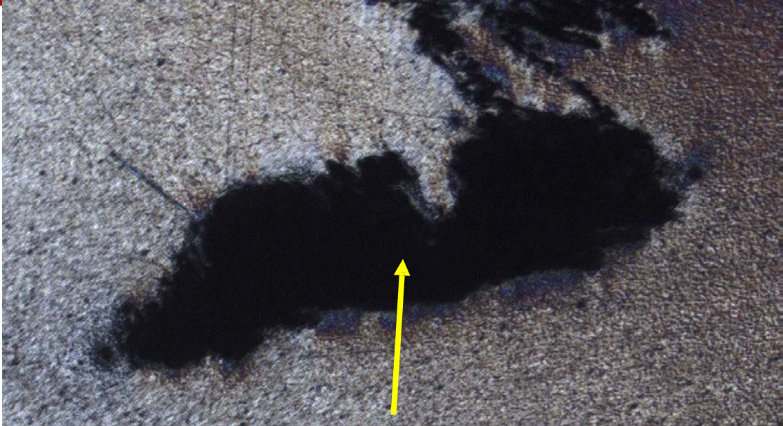
Figura 42. Aglomeración de nano partículas de TiCN en la zona central de procesamiento.
