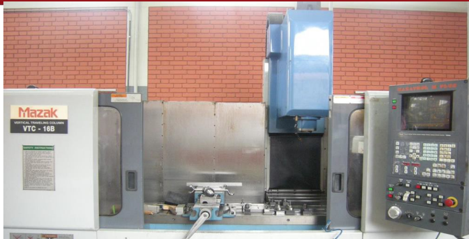
Figura 14. Fresadora CNC del Laboratorio de Manufactura de la Facultad de Ingeniería Mecánica.
