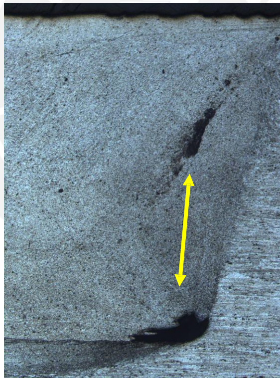
Figura 37. Defectos internos en la probeta AA5083 sin adición de nano TiCN
