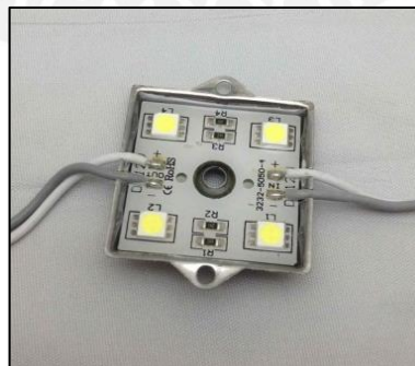
Figura 2-8 Led Ultrabrillante modelo XH-126MCS54A Fuente: http://spanish.globalmarket.com
