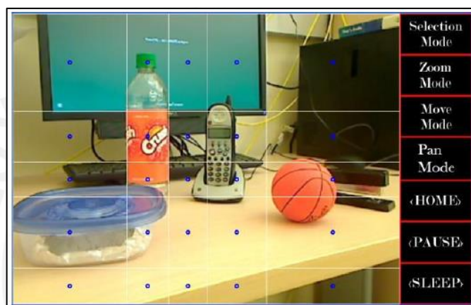
Figura 1-4: Sistema de visión complementado con P300 para coger objetos usando un brazo robótico [10]
