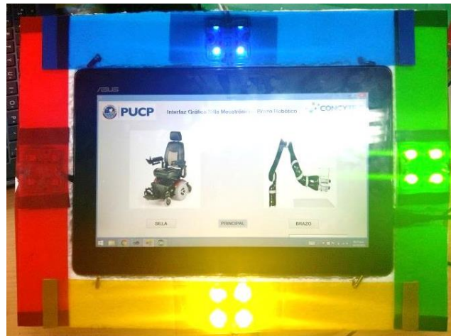
Figura 3-8 Panel de LED con filtros de colores Fuente propia
