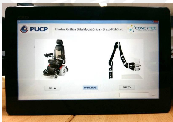
Figura 2-7: Interfaz Gráfica implementado sobre Pantalla Gráfica LCD táctil Fuente propia
