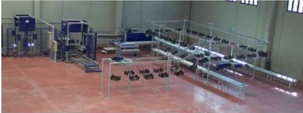
*Fig.4.5. Calibrador electrónico de copas para una central hortofrutícola*
