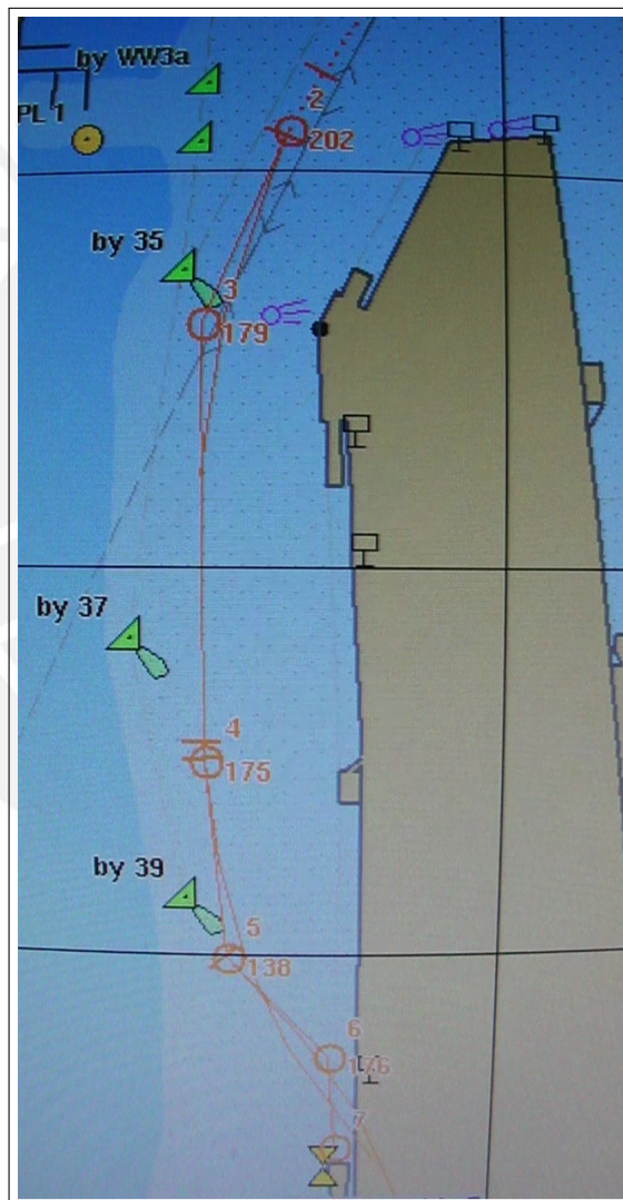
Figura 1.3: Maniobra de atracamiento en el puerto con un sistema de guiado estándar para seguimiento de ruta, (Kurowski et al., 2013)
