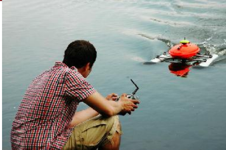
Figura 1.2: Barco teledirigido inalámbricamente mediante radiocontrol, usado para estudios hidrográficos
