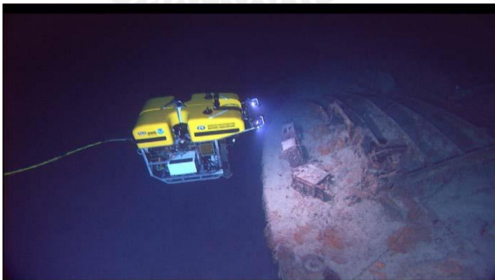
Figura 1.1: Submarino teledirigido mediante cordón umbilical (NOAA, 2005)
