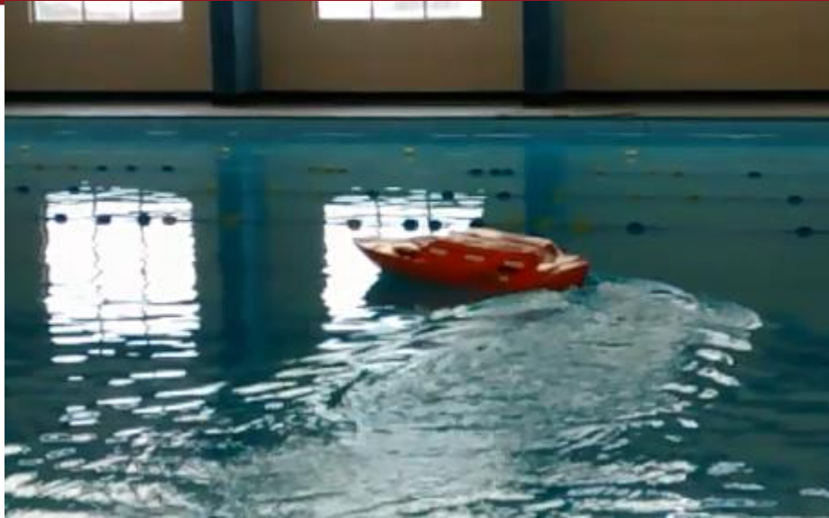
Figura 4.40: Prueba de giro en lazo abierto
