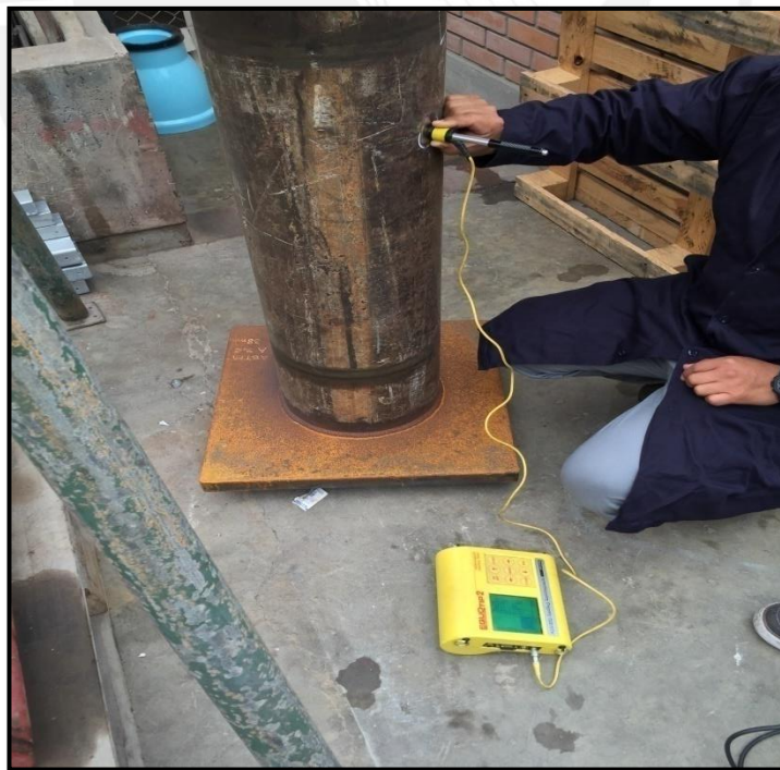
Figura 2.10 Ensayo de dureza en campo.
