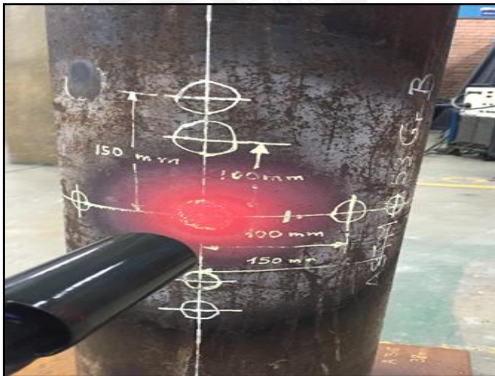
Figura 3.2 Coloración de la tubería durante el segundo daño.
