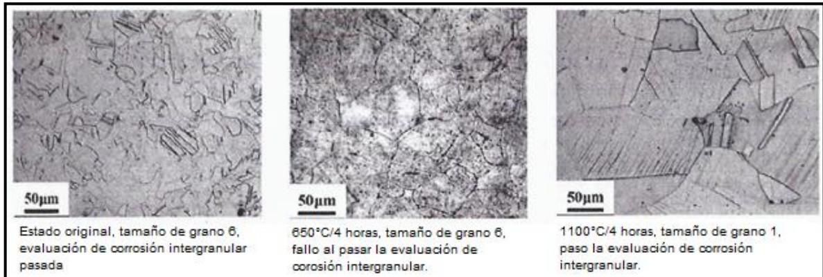
Figura 1.2 Resultados de la prueba de estructura metalográfica y corrosión intergranular a diferentes temperaturas de exposición térmica. [Xuedong Chen, 2012]
