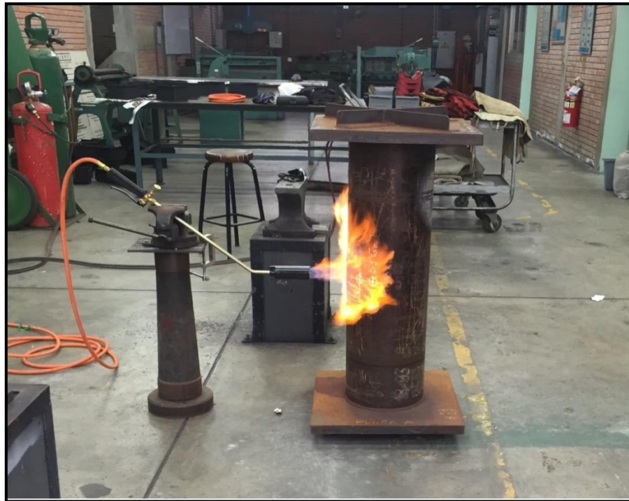
Figura 2.6 Daño por fuego a la tubería.
