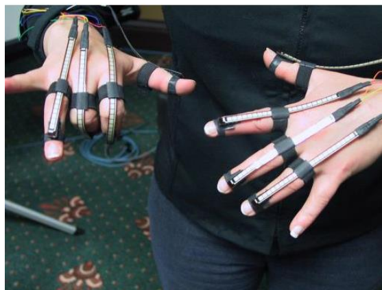
Figura 2.8: Sensor de fuerza por flexión para detectar movimiento de dedo. [27]
