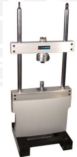
Figura 2.4: Dispositivo de pruebas de fatiga modelo 900 Family Servo Hydraulic Fatigue Test. [22]
