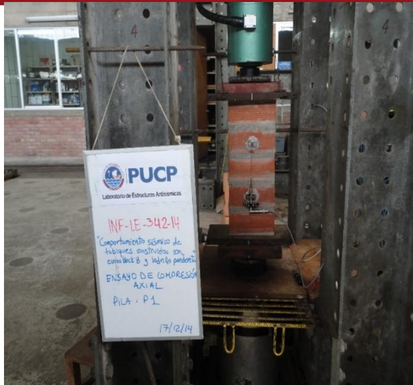
Foto 10. Ensayo de compresión axial en la pila P1 de 52.3 cm x 22.5 cm.
