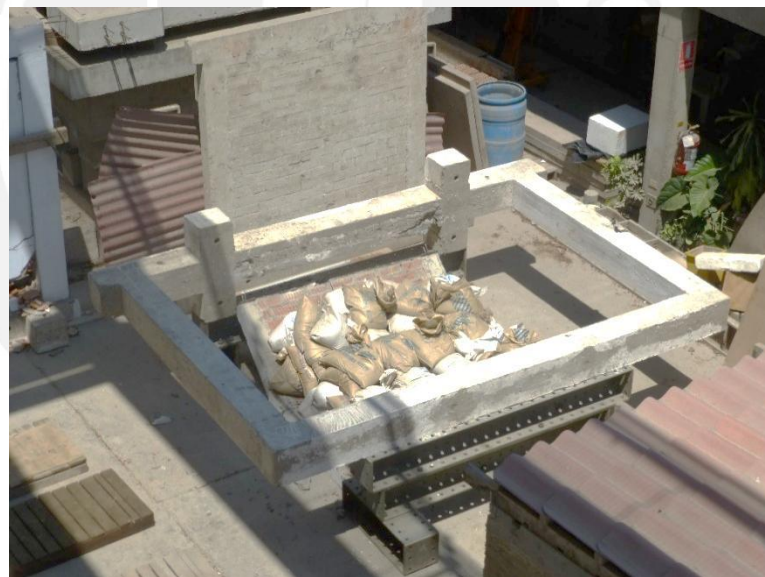
Foto 71. Falla por flexión con 64 bolsas de arena.
