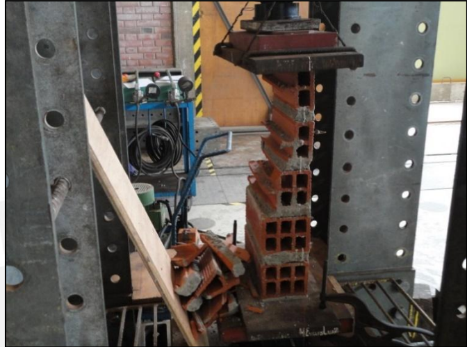
Foto 14. Falla de pila P1 de ladrillo pandereta.
