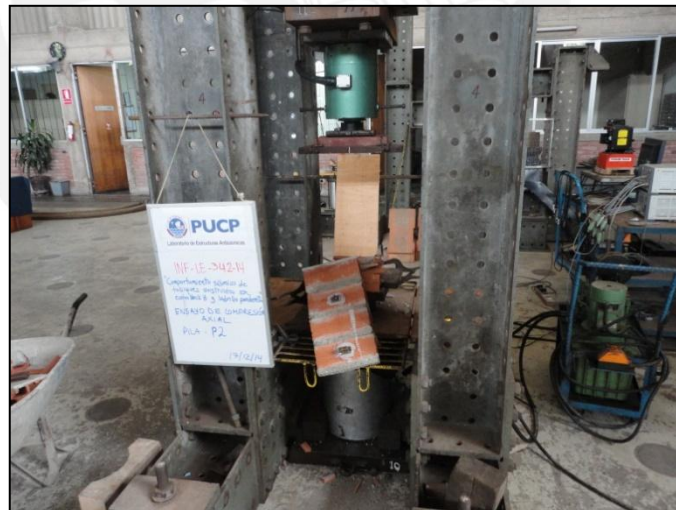
Foto 15. Falla de pila P2 de ladrillo pandereta.
