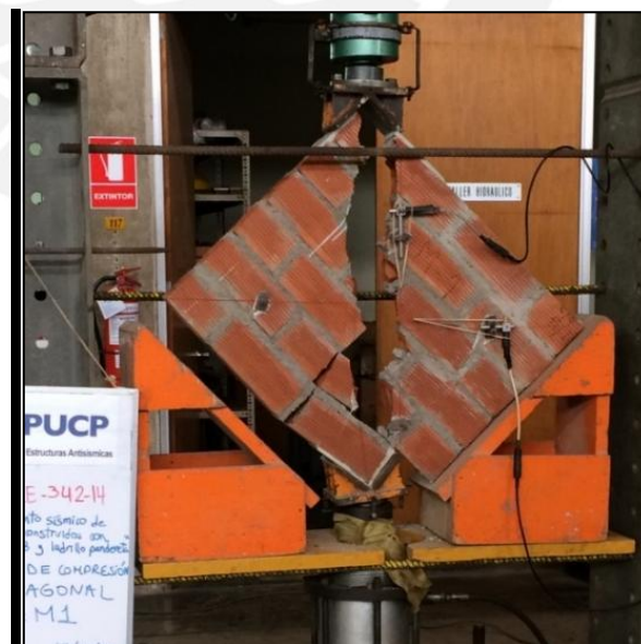
Foto 26. Falla de murete M1.
