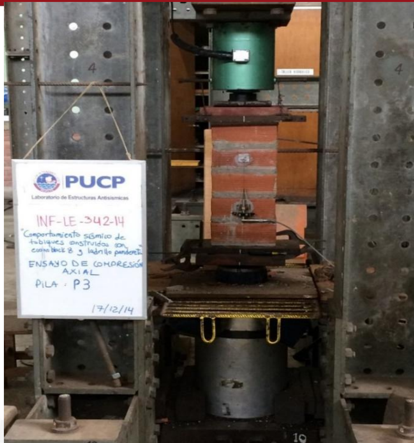
Foto 12. Ensayo de compresión axial en la pila P3 de 52.7 cm x 22.5 cm.
