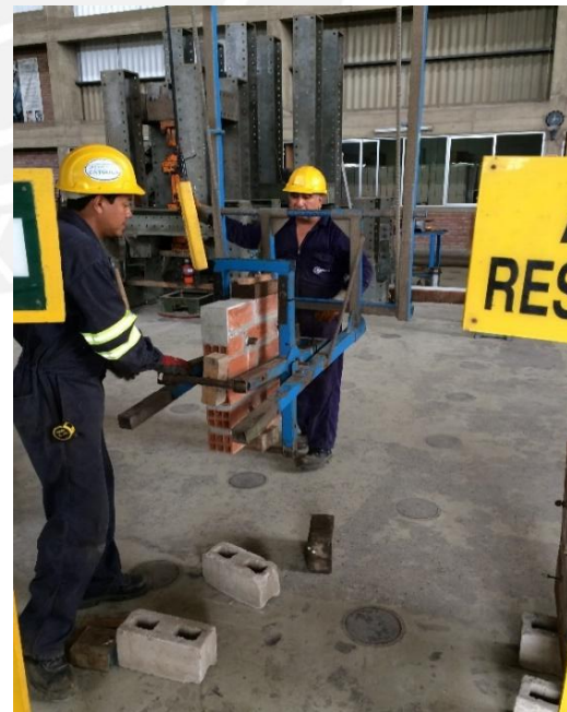
Foto 22. Personal encargado de trasladar los muretes, a través del dispositivo de izaje.
