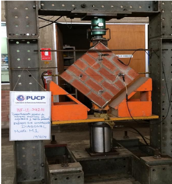
Foto 23. Murete M1 de 59 cm x 58.8 cm. Longitud vertical local inicial de 40.8 cm y longitud horizontal local inicial de 40.5 cm.
