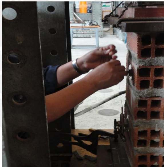
Foto 9. Colocación de dispositivos LVDTs calibrados a cada pila antes de ser ensayados.
