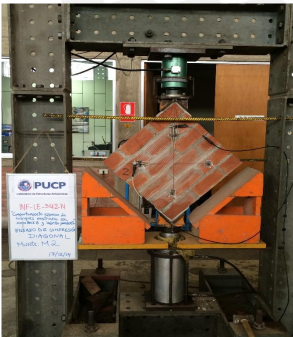
Foto 24. Murete M2 de 58.5 cm x 58.5 cm. Longitud vertical local inicial de 39.6 cm y longitud horizontal local inicial de 40.2 cm.
