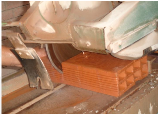
Foto 29. Corte de ladrillos con máquina.
