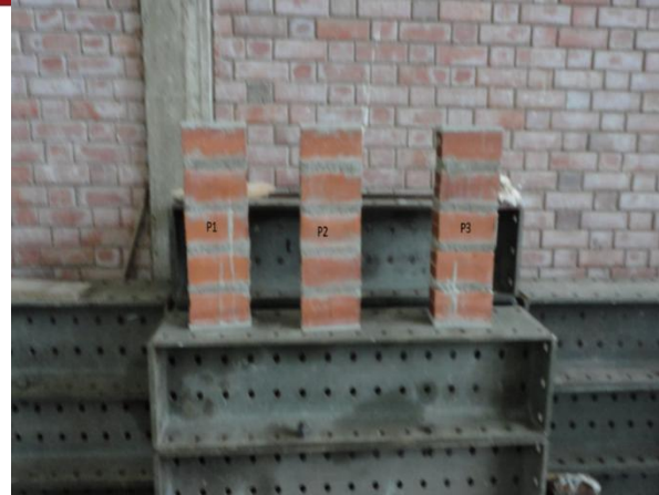
Foto 6. Pilas antes de ser sometidas al ensayo de compresión axial.
