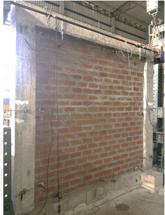
Foto 42. Instrumentación colocada para tabique con ladrillo pandereta.
