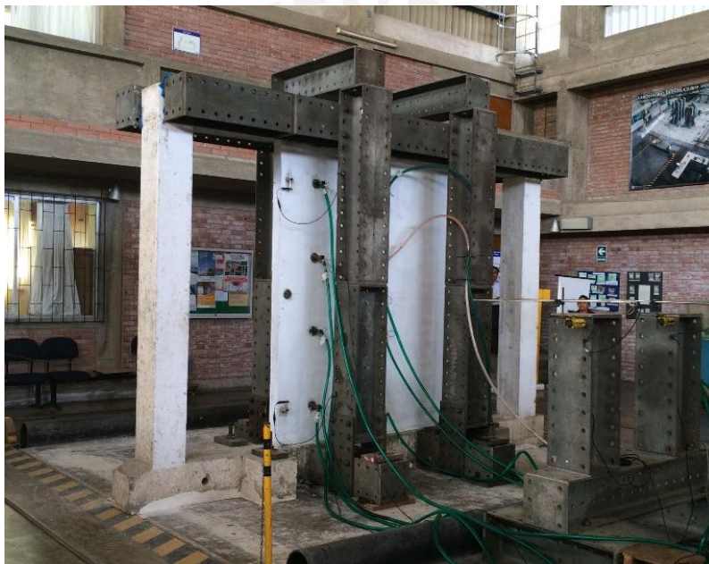
Foto 55. Pórtico con tabique sobre el simulador de sismos.
