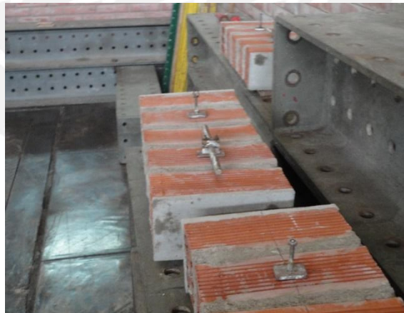
Foto 7. Alineación de la instrumentación antes de ser pegadas a la superficie del ladrillo.
