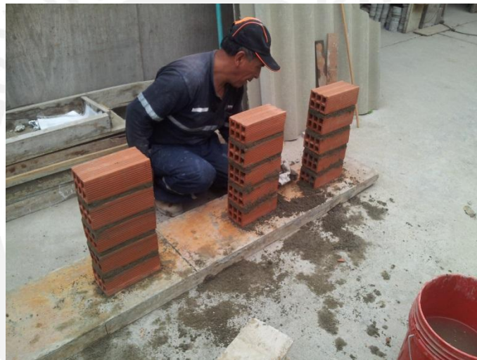
Foto 5. Vista de las 03 pilas a ensayar.
