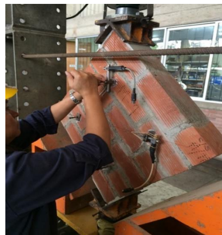
Foto 20. Personal colocando los LVDTs, vertical y horizontal.
