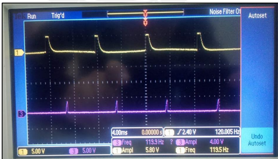
Figura4.4 Pulsos de activación de Triac[Elaboración Propia]
