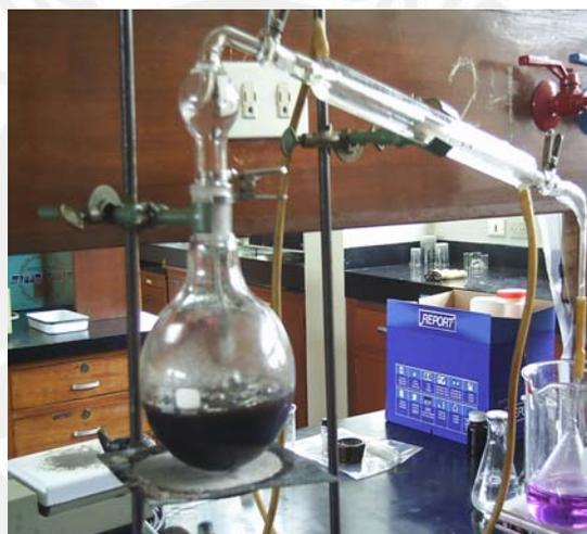
Figura 1: Equipo para la determinación del contenido de nitrógeno
