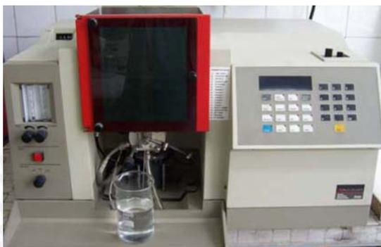
**Figura 3.4.** Espectrofotómetro de absorción atómica Perkin-Elmer modelo 2500
