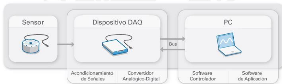
Figura 3.4: Concepto de funcionamiento de DAQ.
