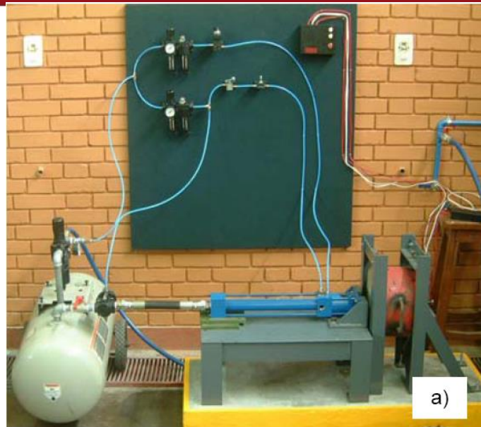
Figura 1.7: Equipo de Laboratorio para ensayos de impacto entre barras cortas.
