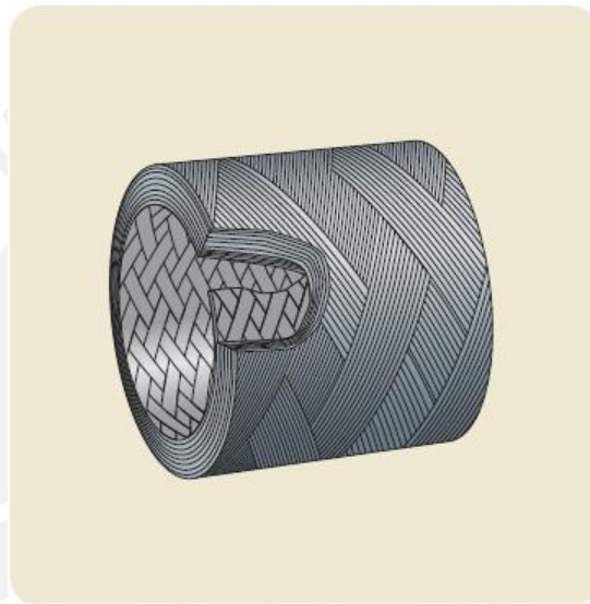
Figura 2.16: Sección transversa de Cojinete PWM.
