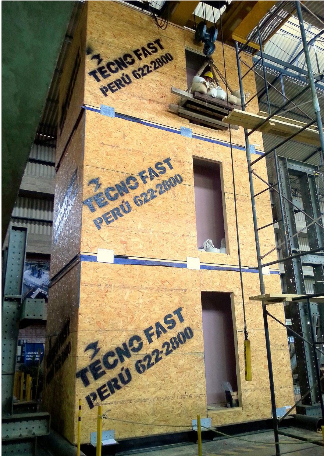
Ilustración 6. 5 Foto del módulo real. Proceso de colocación de carga viva en el 3er nivel
