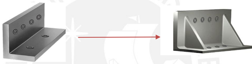
Ilustración 9.1 (Izquierda) Escuadra metálica utilizada en el ensayo.
