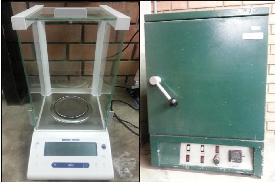
**Figura 49.** Balanza analítica (lado izquierdo) y horno de convección (lado derecho).
