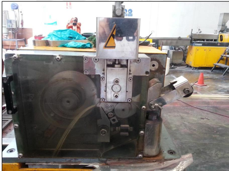
**Figura 62.** Filamentos tensionados por la granuladora.
