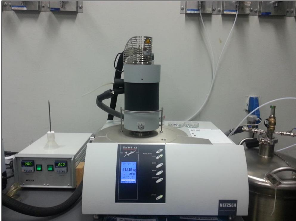
*Figura 65. Equipo para TGA y DSC NETZSCH STA 449 F1 Júpiter®.*
