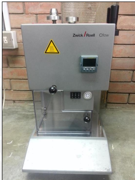
**Figura 64.** Medidor del índice de fluidez Zwick/Roell Cflow Extrusion Plastomer.
