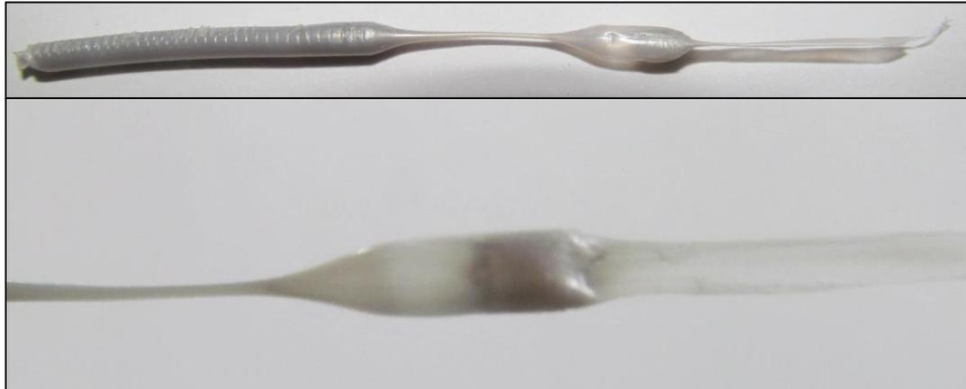
**Figura 67.** *Burbuja generada en el interior del extrusor debido a la humedad presente en el filamento.*
