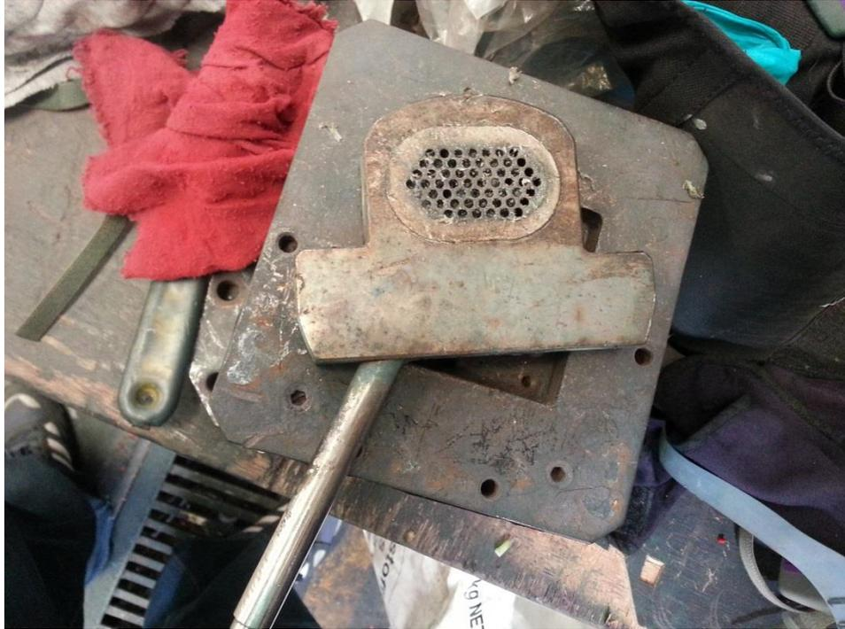
**Figura 54.** Plato rompedor de la extrusora Labtech Scientific LTE26 40L/D.
