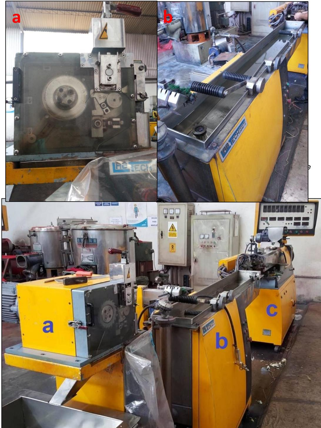
**Figura 56.** Línea completa de extrusión: (a) granuladora, (b) cubeta de enfriamiento por agua y (c) extrusora de doble tornillo.
