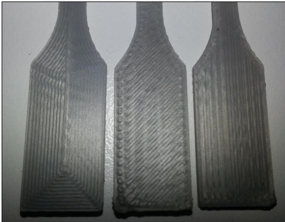
**Figura 68.** *Probetas de tracción impresas con distintas configuraciones.*
