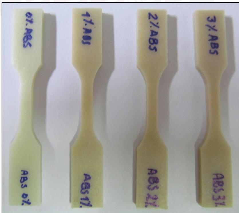
**Figura 76.** Probetas de tracción a partir de filamentos extruidos de ABS con distintos contenidos de nanoarcillas.
