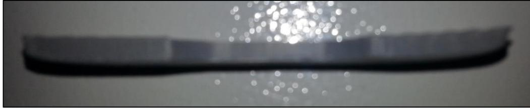
**Figura 69.** Alabeo de una probeta de tracción impresa de ABS debido a una mala selección de la temperatura de la plataforma.
