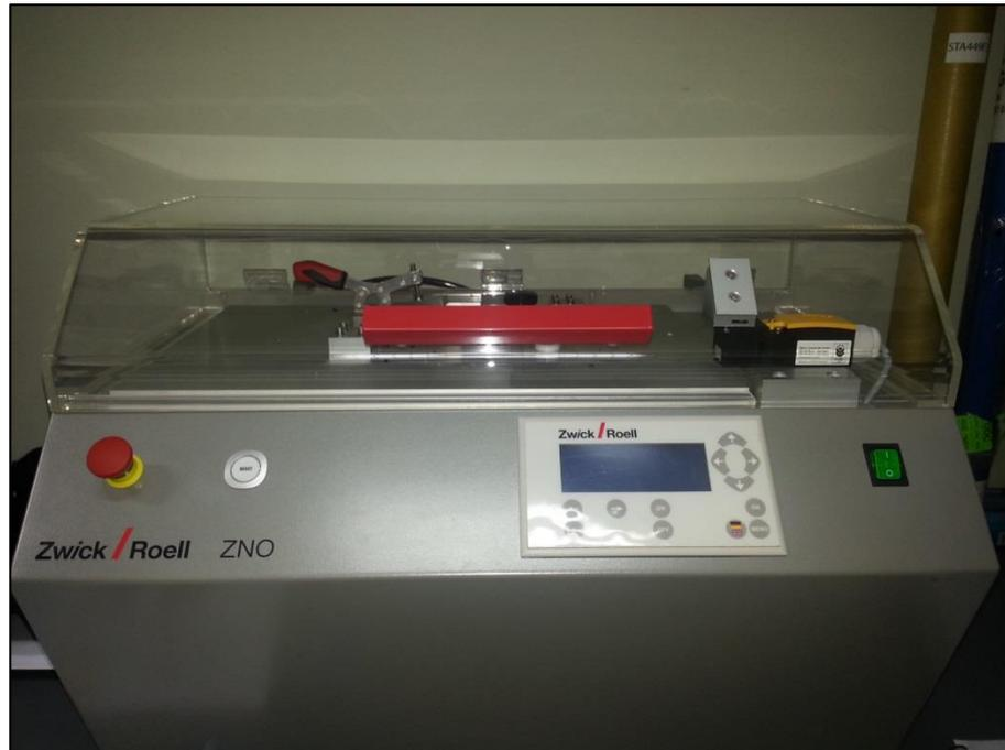
**Figura 73.** Máquina de corte de entallas automático Zwick/Roell ZNO.
