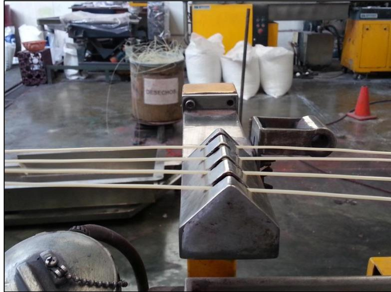
**Figura 61.** Dispositivo de succión del agua impregnada en la superficie de los filamentos enfriados.
