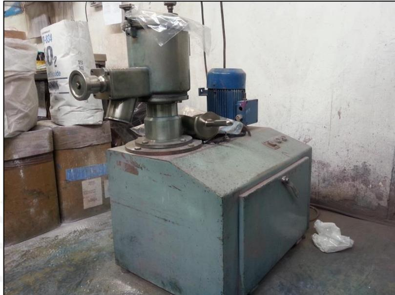
*Figura 51. Mezclador de cuchillas.*
