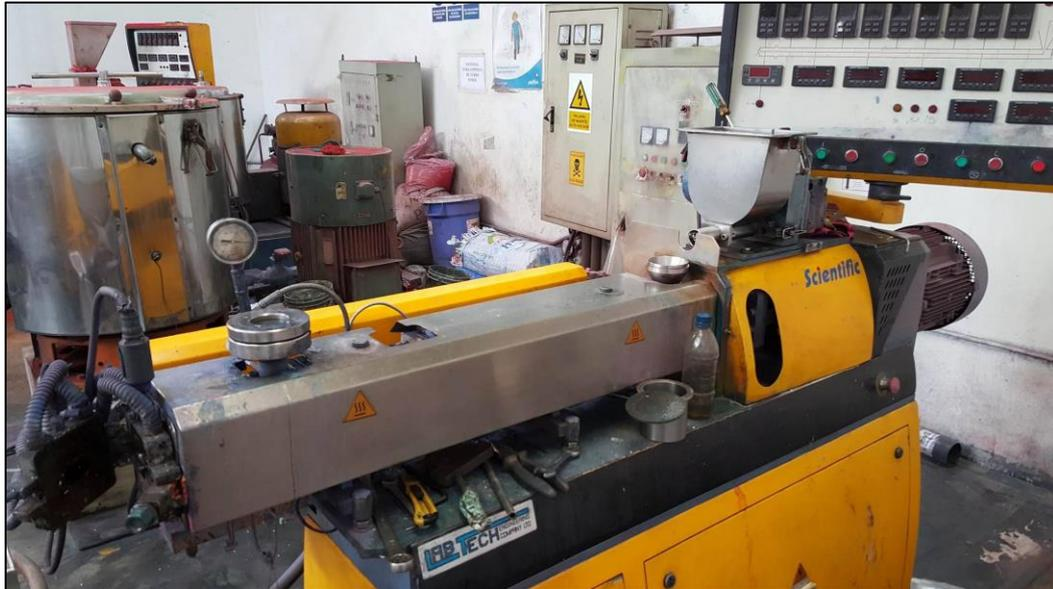
*Figura 52. Extrusora de doble tornillo Labtech Scientific LTE26 40L/D.*
