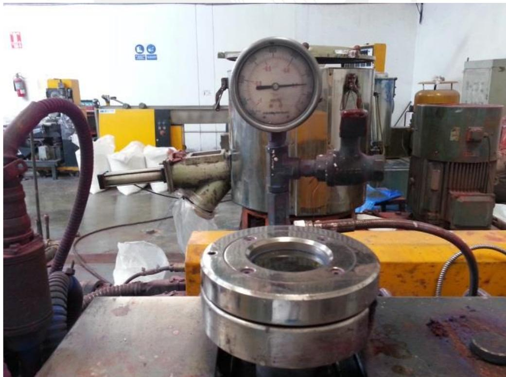
*Figura 53. Vacuómetro de la bomba de vacío ubicado la última zona de calentamiento.*
