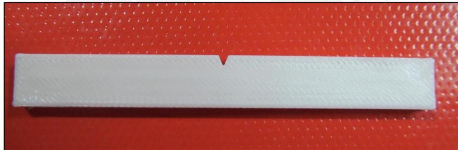
**Figura 74.** Probeta de impacto impresa de PLA con entalla maquinada.
