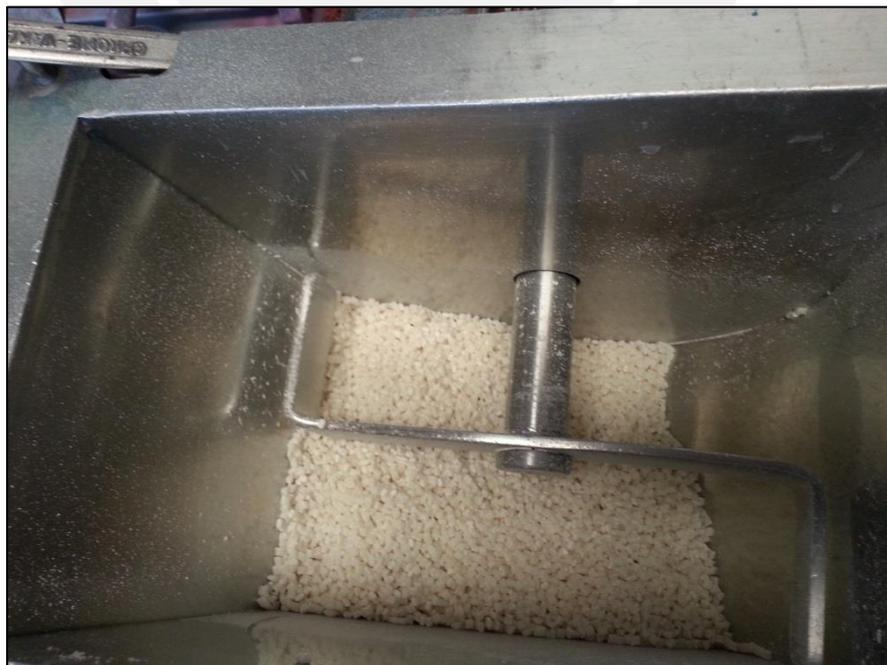
*Figura 58. Material introducido en la tolva de alimentación.*
