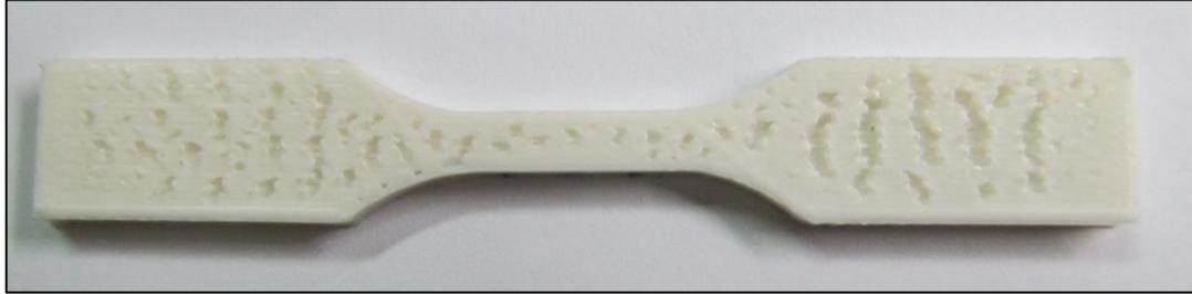
**Figura 66.** *Probeta de tracción con una deposición discontinua de filamento fundido.*
